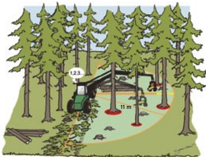
Kuva 5. Koneenkuljettaja voi seurata harvennusvoimakkuutta ajouralta käsin lukemalla puoliympyrän sisään jäävät puut ja vertaamalla tulosta keskiläpimittaan perustuvaan harvennusmalliin.
