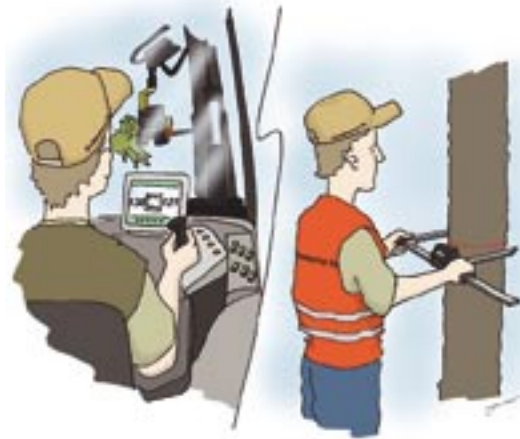
Kuva 4. Jäävän puuston keskiläpimittaa arvioidessaan kuljettaja voi hyödyntää hakkuukoneen mittalaitteen näyttämiä lukemia vastaavankokoisista poistettavista puista. Keskiläpimitan tarkka arviointi on tärkeää, jotta siihen perustuva harvennusmalli antaa oikean jäävän puuston määrän. Kuljettajan onkin tarkistettava keskiläpimitta-arvionsa mittaamalla päivittäin.
