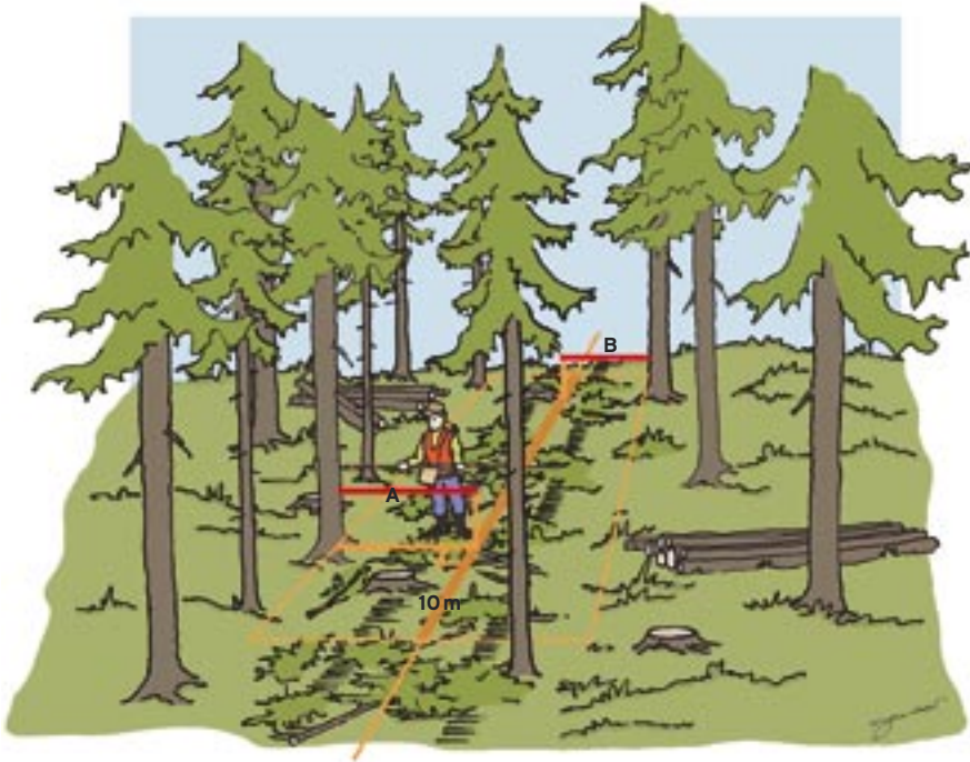
Kuva 10. Ajouran leveyden mittaus.
