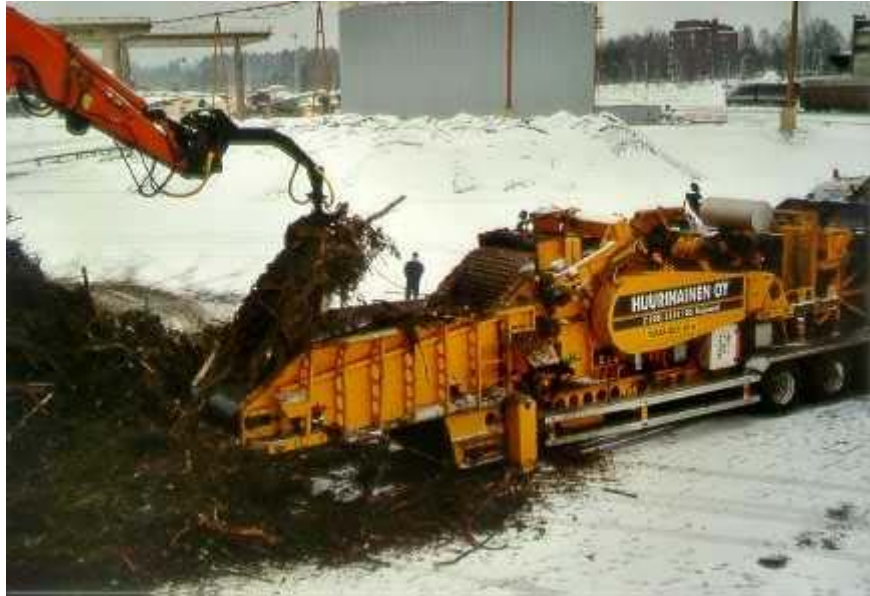
Kuva 3. CBI Magnum Force 4860 HZ -roottorimurskain, Huurinainen Oy, Kajaani.
