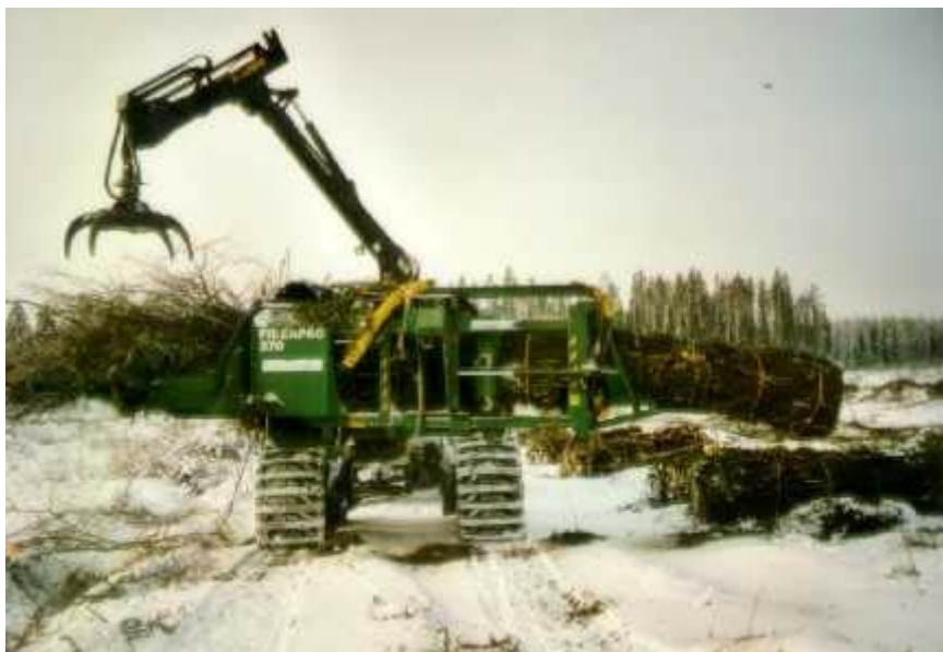
Kuva 2. Fiberpack 370 -oksapaalain keskikokoisen Timberjack 1210 B -kuormatraktorin alustalle asennettuna. Omistaja Konepalvelu Hölrin Oy, Korttesjärvi.
