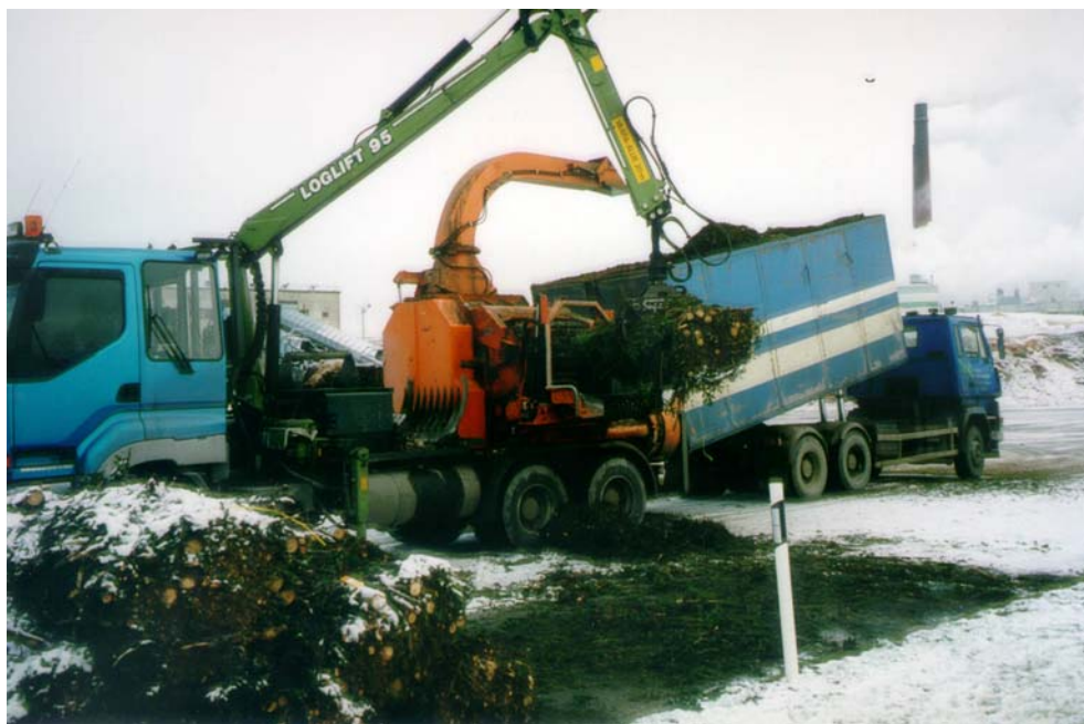
Kuva 5. TT-1310RML -rumpuhakkuri oksapaalien haketuksessa, Hakeyhtymä Kankaanmäki Oy, Tuulos.
