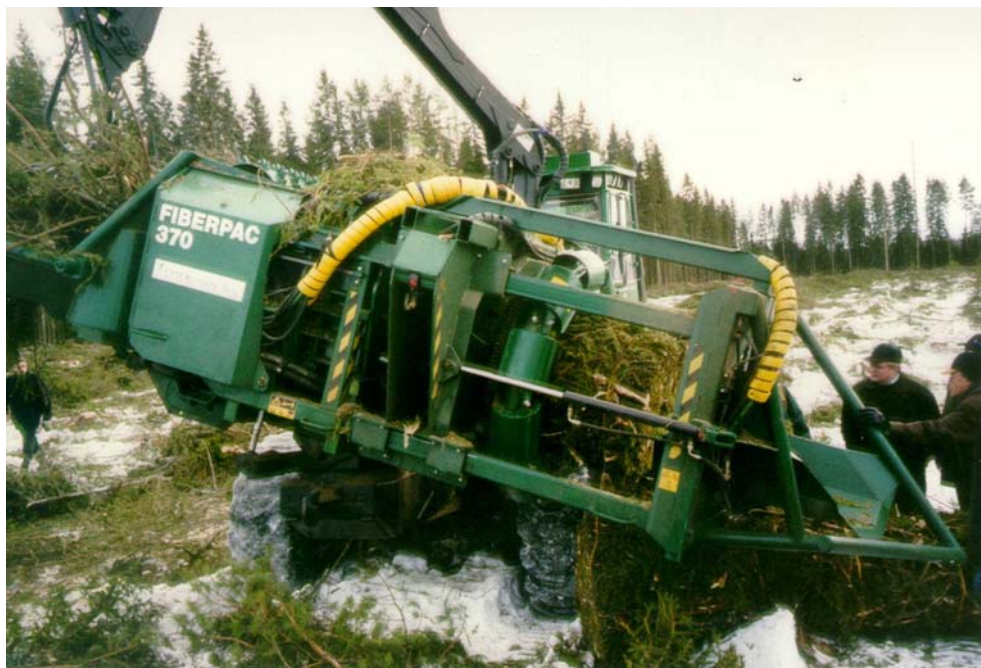
Kuva 1. Ensimmäinen Suomessa käyttöön otettu Fiberpack 370 -oksapaalain hakkuukonealustalle asennettuna. Omistaja Ris-Esset Ab, Ähtävä. Valokuvat Metsäteho Oy.
