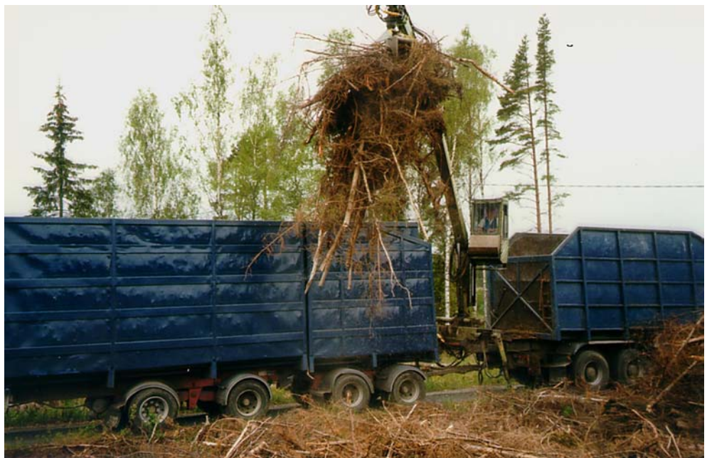
Kuva 7. Kuljetusliike Hakonen S. ja Pojat Ky:n (Pori) rakentama hakkuutähdeauto, jossa on teleskooppirunkoinen perävaunu.
