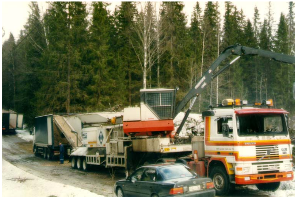
Kuva 4. Diamond Z 1460 BL -roottorimurskain, Vertainen Oy, Konginkangas.
