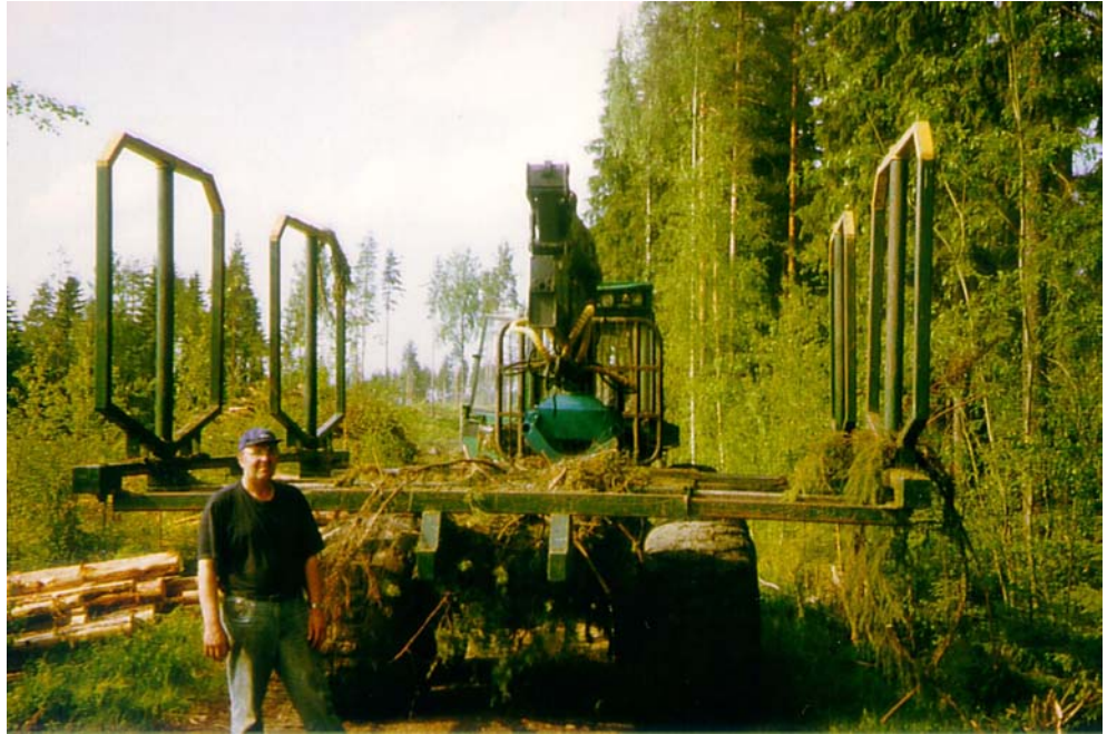
Kuva 6. Hakkuutähdevarusteisella kuormatraktorilla kuorman keskikoko oli yli 10 m 3 , metsäkoneyrittäjä Ahti Salo, Pälkäne.
