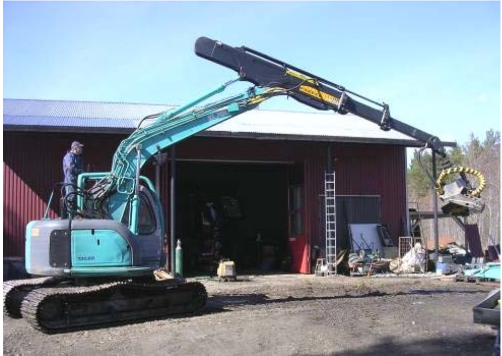
KUVA 4. Kobelco SK135SRLC -kaivukone varustettu Ponsse HN200 -liukupuomilla ja Ponsse H53 -hakkuulaitteella.
