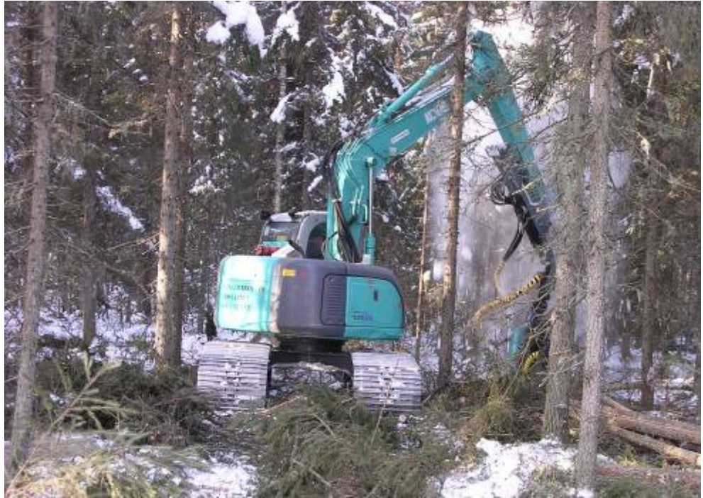
KUVA 2. Korpikuusikon toinen harvennus Kobelco SK135SRL -kaivukoneharvesterilla, jossa Foresteri 22RH -hakuulaite. Ylävaunua käännettäessä peräilytystä ei tapahdu. Valokuvat: Metsäteho Oy / Jouni Bergroth.
