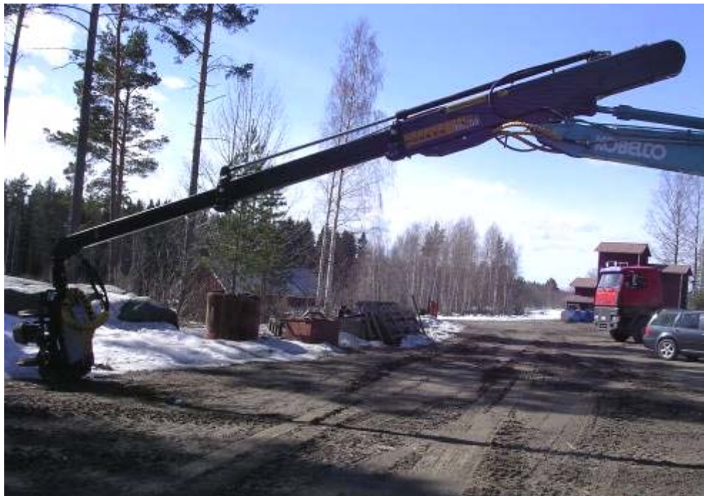
KUVA 5. Kobelco SK135SRLC -kaivukoneeseen asennettu Ponsse HN200 -liukupuomi työnnetty maksimipituudelle, 11 metriin.
