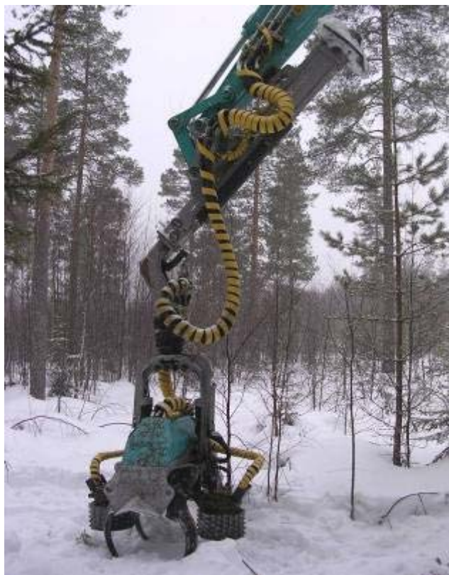
KUVA 3. Kaivupuomin päähän asennettu Foresteri X-Tender 15 -jatkekäpälä ja Foresteri 25RHS -hakuulaite.
