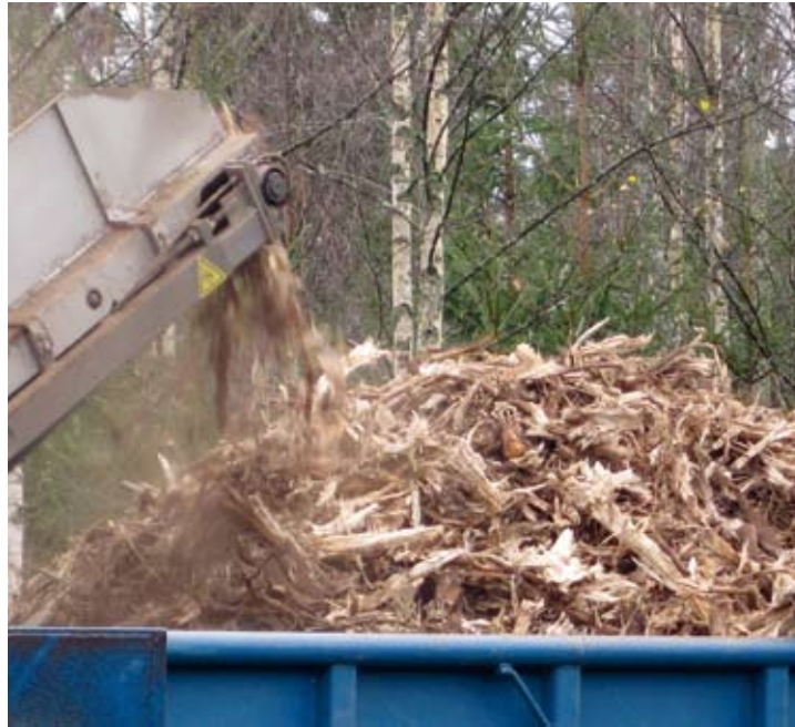
↑ Harvalla (500x320 mm) seulalla testissä 2 tehtyä esimurskettä hakeauton lavalla.
