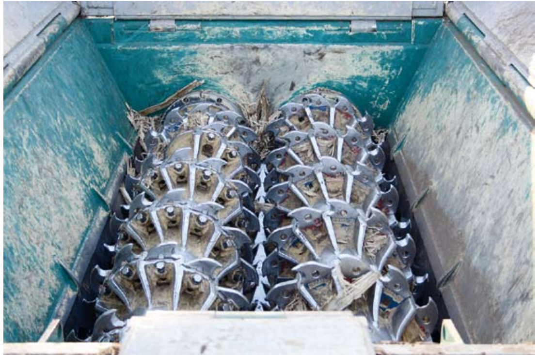
↑ Itävaltalaisvalmisteisissa Crambo-murskaimissa on kaksi vastakkain pyörivää, ruuvimaista murskaintelaa, joiden pituus on 2 820 mm ja halkaisija 610 mm. Koukkumaisia murskainteriä on teloissa yhteensä 134 kappaletta.
