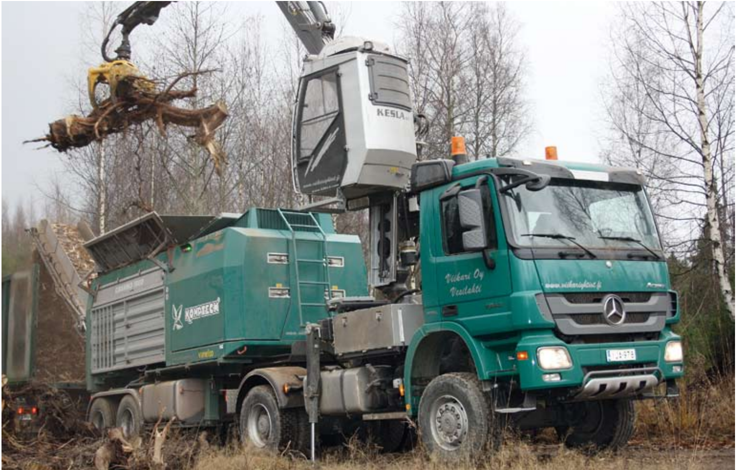
Kantojen esimurskausta tienvarsivarastolla Kuljetusliike Viikari Oy:n Crambo 5000 -murskaimella. Murskaimessa on Caterpillar C13 -moottori, joka kehittää 328 kW:n (446 hv) tehon. Murskaimen siirtoautona on nelivetoinen Mercedes-Benz Actros 1844 4x4. Valokuvat: Kalle Kärhä, Metsäteho Oy.
