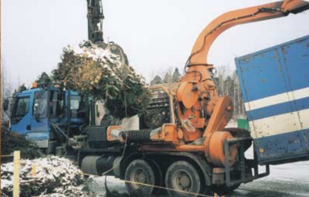
Kuva 3. Pienkäyttäjillä käyttöpaikallahaketus voisi perustua mobiilihakkureiden käyttöön. Kuvassa Heinolan Sahakoneet Oy:n TT-1310RML-hakkuri oksapaalien haketuksessa.
