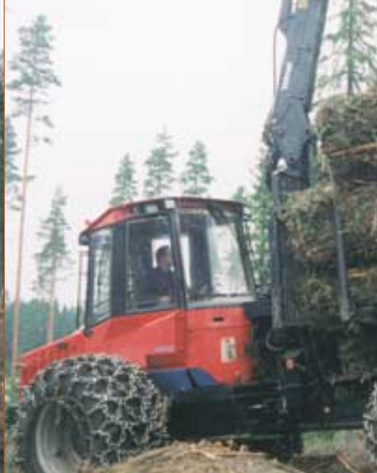
Kuva 2. Keskikokoiseen kuormatraktoriin mahtuu noin 13 oksapaalia, joista kertyy 5 tonnin lasti.
