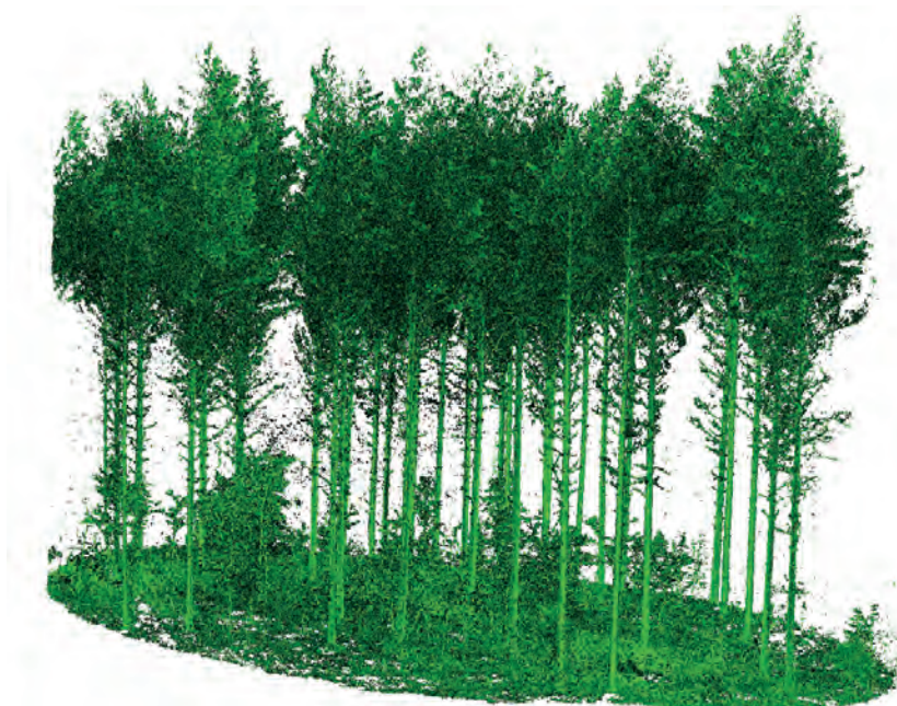
Kuva 14. Tulevaisuudessa tuotetaan yhä tarkempaa puukohtaista tietoa. Esimerkiksi maalaserilla (TLS) tuotettu pisteparvi mahdollistaa paremman laaturunnusten huomioon ottamisen (kuva: Ville Kankare/Helsingin yliopisto).
