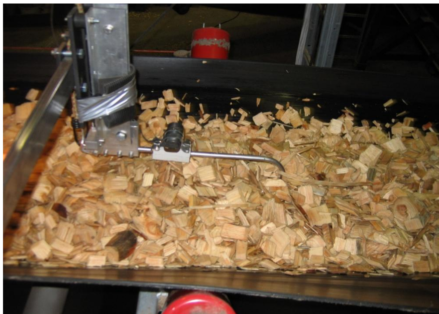
Kuva 65 Impedanssimittauksissa käytetty torpedo-sondi linjamittauksessa. Akustisen emission anturi on kytketty sondin yläpuolella olevaan adapteriin.
