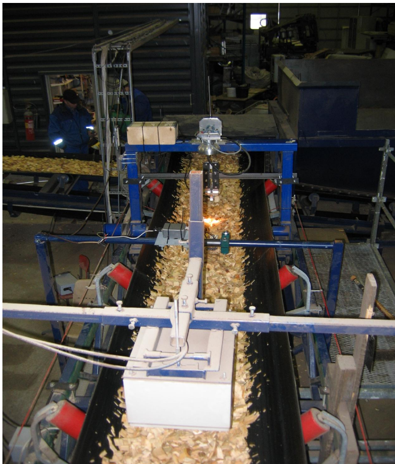
Kuva 1 Koelinja 25.10.07-selluhakeajossa, edessä NDC:n ir- kosteusmittari ja radiometrinen tiheysmittaus ja ylhäällä impedanssi- ja nir-mittaukset.
