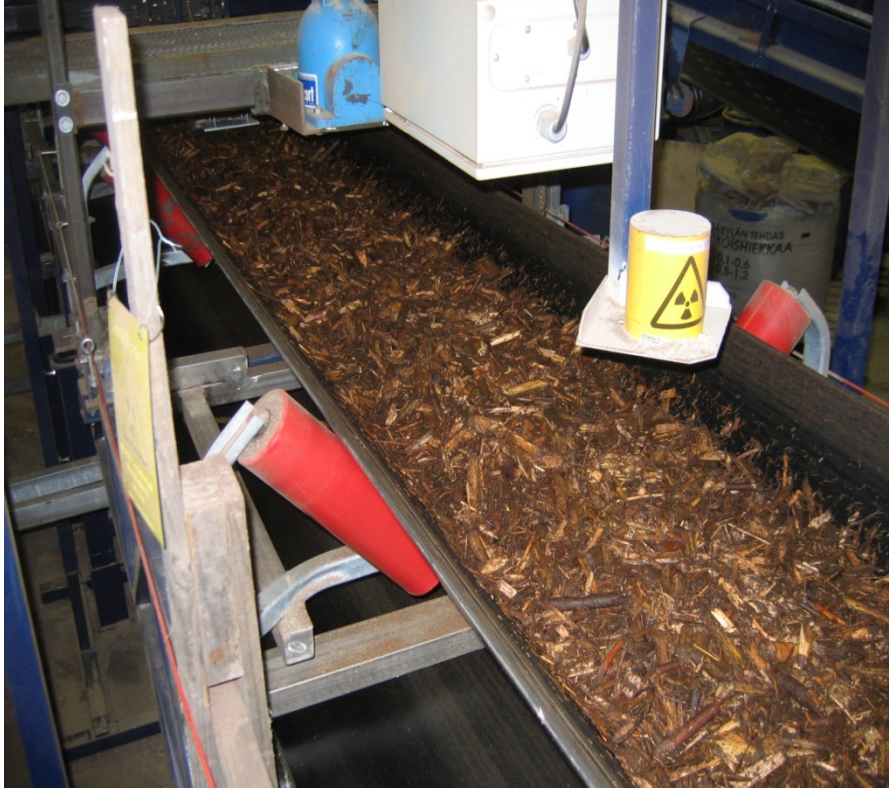
Metsähaketta ja radiometriset mittaukset, niiden välissä ir-mittari.
