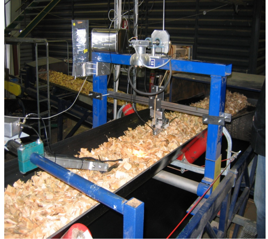
Teollisuushaketta, nir-mittapää ja kaksi impedanssimittausta.
