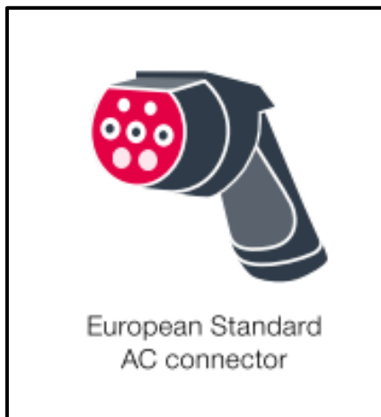
Kuva 13. AC-liitin kolmivaiheiselle vaihtovirralla (mode 3, EN 62196-2) (MAN ei pvm.).
