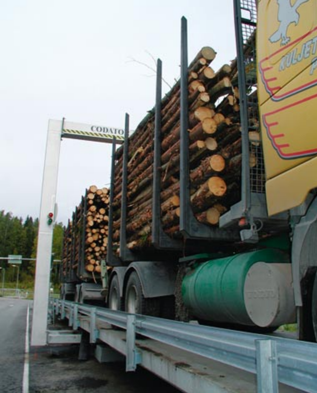
Kuva 1. Laser-skannauksen perustuvan Modus 2000 -mittauksen toimintaperiaate.
