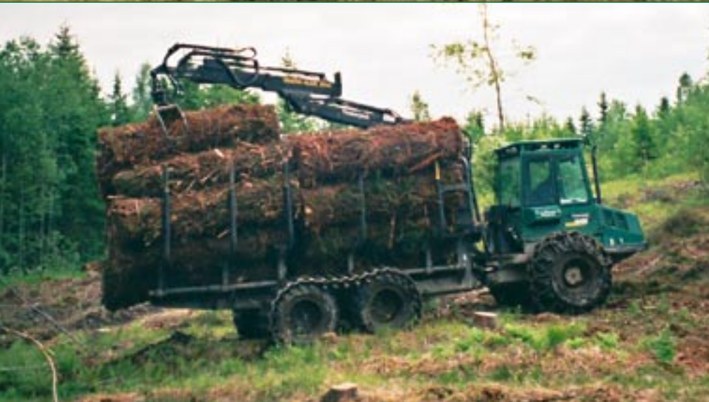
Kuva 2. Metsätraktorin kuormatilan on oltava jatkettu, kun paaleja kuljetetaan pidempiä matkoja. Kuvan metsätraktoriin on asennettu yksi lisäkarikkapari.
