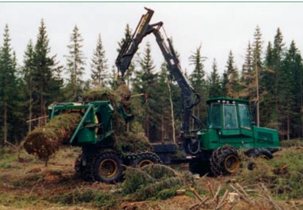
Kuva 1. Pääosa Suomessa käytössä olevista paalaimista on Timberjack Oy:n valmistamia. Paalain tekee jatkuvaa, 70–75 senttiä paksua hakkuutähdepötköä, joka katkaistaan ketjusahalla noin kolmen metrin pituisiksi risutukeiksi.
