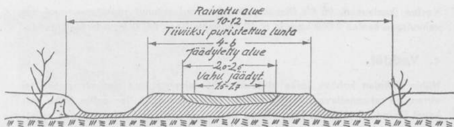
Kuva 28. — Aukeille paikoille ympäristöään korkeammaksi rakennetun pengertien periaate.
