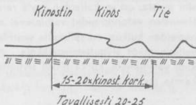
Kuva 20. — Tuulta jarruttavan kinostimen vaikutus kinoksen muodostumiseen.
