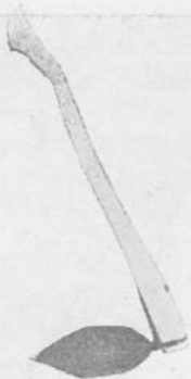
Kuva 41. — Tiemiehen varusteisiin kuuluva turvekuokka, joka soveltuu ajoradan tasaamistoihin jo tien raivausvaiheessakin.
