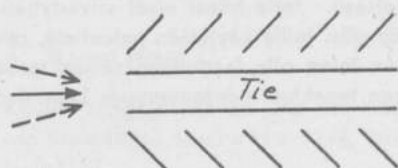
Kuva 19. — Jos tuuli puhaltaa tien suuntaan, sijoitetaan kinostimet väkittävästi avaruusvallien taakse vinoon, jolloin ne ohjaavat tuulen tieltä syrjään. Menetelmää joudutaan usein käyttämään ennen maanleikkausten ja notkojen alkukohtia.
