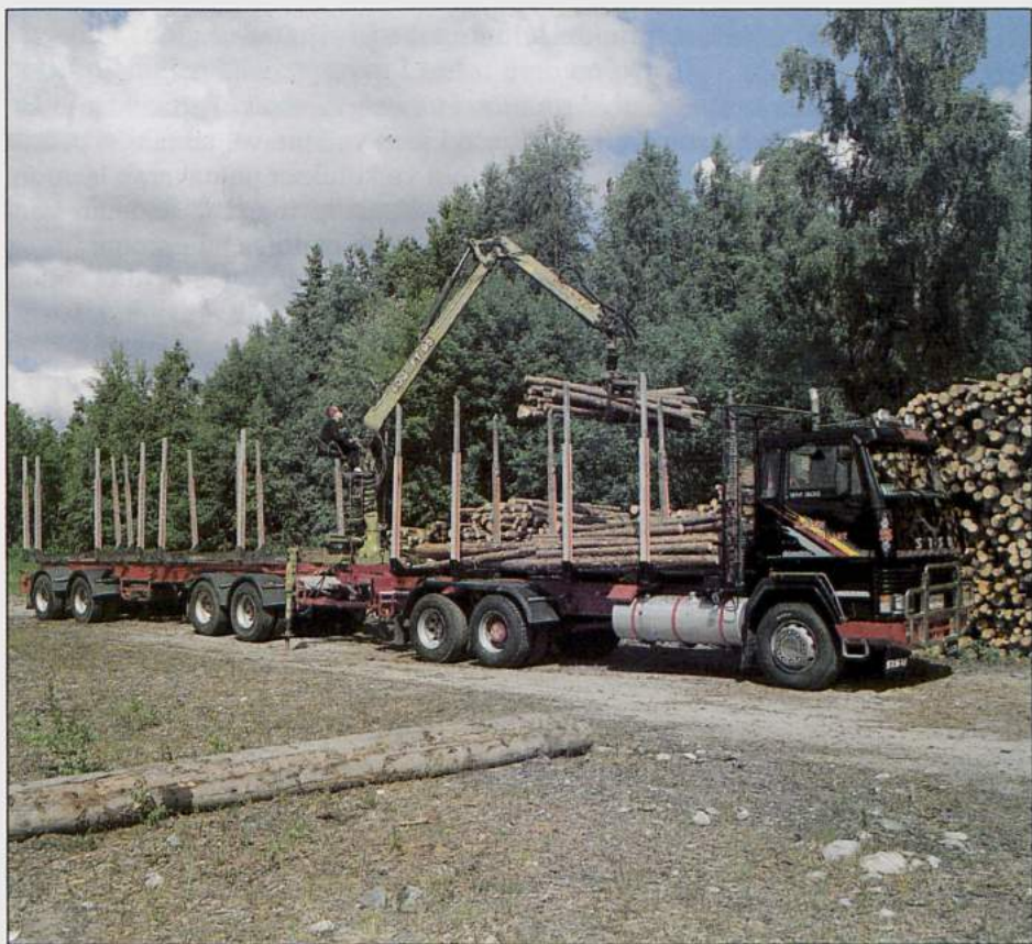
3-akselisen vetoauton ja 4-akselisen perävaunun yhdistelmä on yleisin puutavaran kuljetuksessa.
