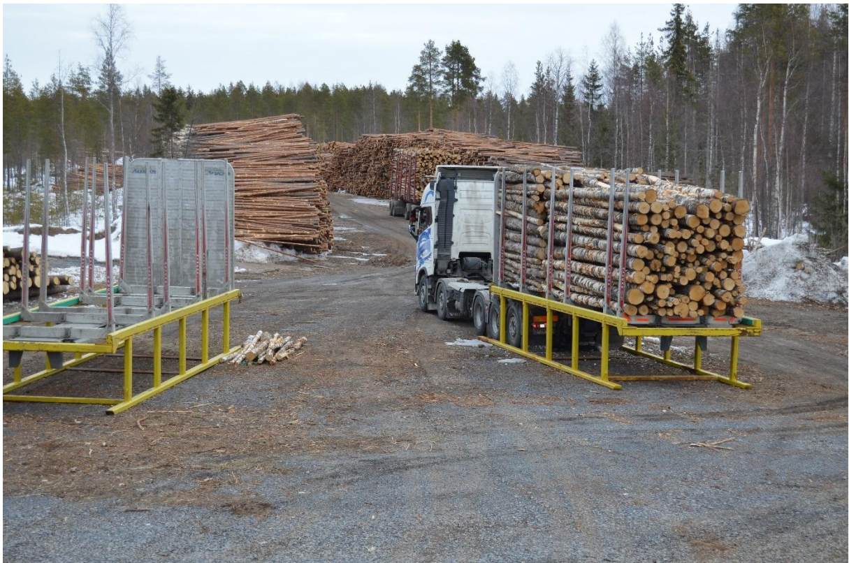
Kuva 15. Moilaspoikien HCT-auto on jättänyt tyhjän jalkalavan terminaaliin ja ottaa kyytiin valmiiksi lastatun (Metsähallitus Metsätalous Oy).
