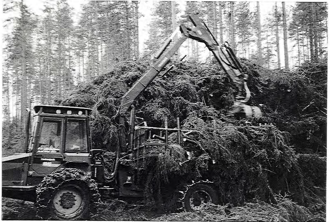
Kuva 8. Vakiokuormatilalla hakkuutähdekuorman koko on noin viisi kiintokuutiometriä. Valokuva Metsäteho Oy.
