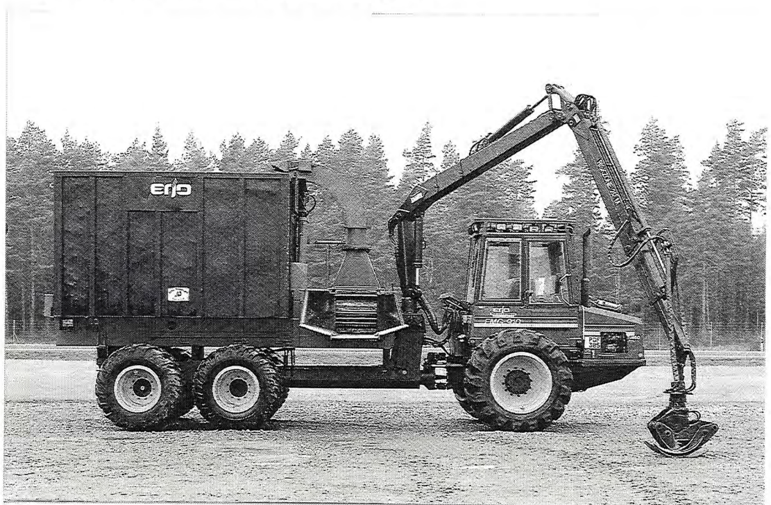
Kuva 9. Tyypillinen ruotsalainen palstahakkuriksi varustettu kuormatraktori. Kuva Erjo Ab:n esite.
