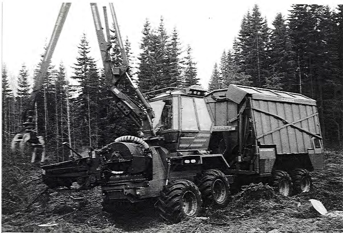
Kuva 10. Oy Logset Ab:n valmistama Chipset-palstahakkuri. Valokuva Metsäteho Oy.
