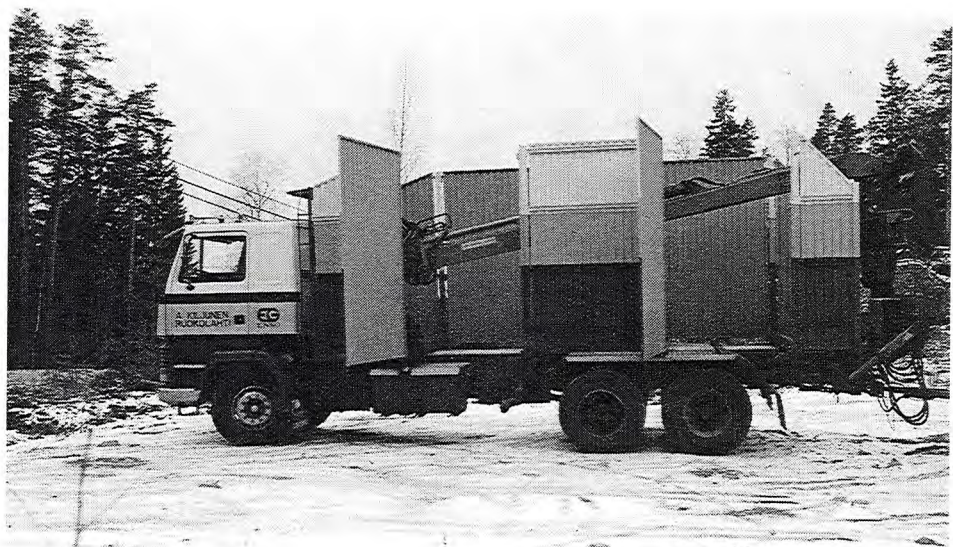
Kuva 3. Osapuuauto, jossa on laitamateriaalina profiilipelti ja laidat saranoitu avattaviksi. Valokuva A. Weckman & Kump. Ky.
