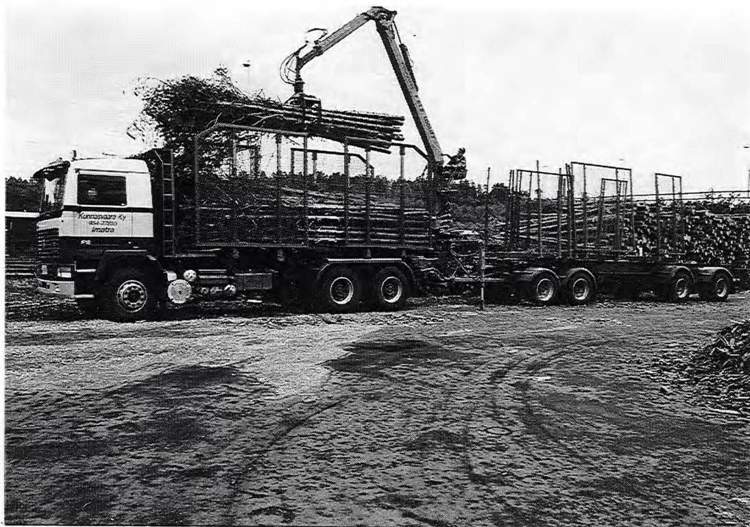
Kuva 17. Pertti Szepaniak -yhtiöiden kevytrakenteisilla laidoilla varustettu osapuuauto. Valokuva Metsäntutkimuslaitos, H. Kalaja.
