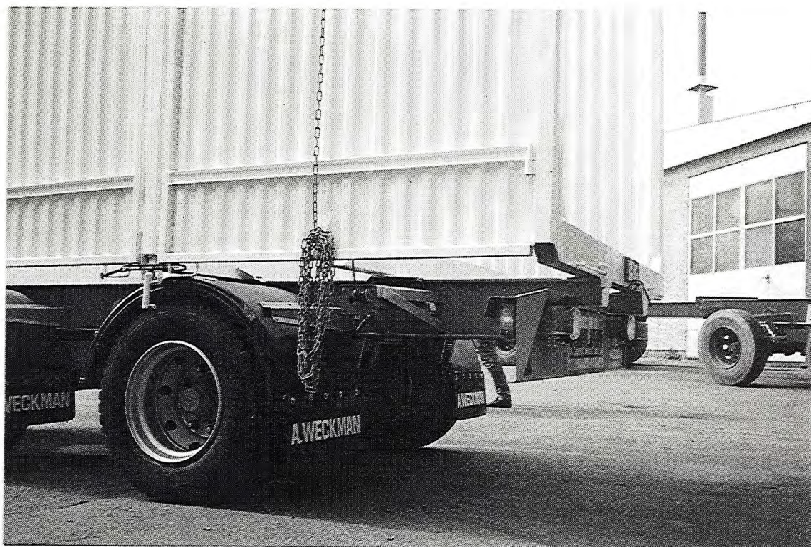
Kuva 15. Hydraulikäyttöinen kuormansiteen kiristin osapuutautossa. Valokuva A. Weckman & Kumpp. Ky.
