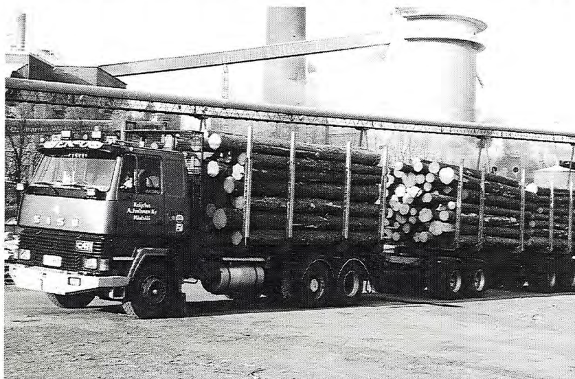
Kuva 2. Kolmiakselinen vetoauto ja neliakselinen perävaunu täydessä tukkilastissa. Valokuva Metsäteho Oy.
