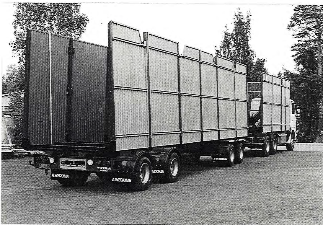
Kuva 18. Saranoiduilla profiilipeltilaidoilla varustettu osapuuauto. Valokuva A. Weckman & Kumpp. Ky.
