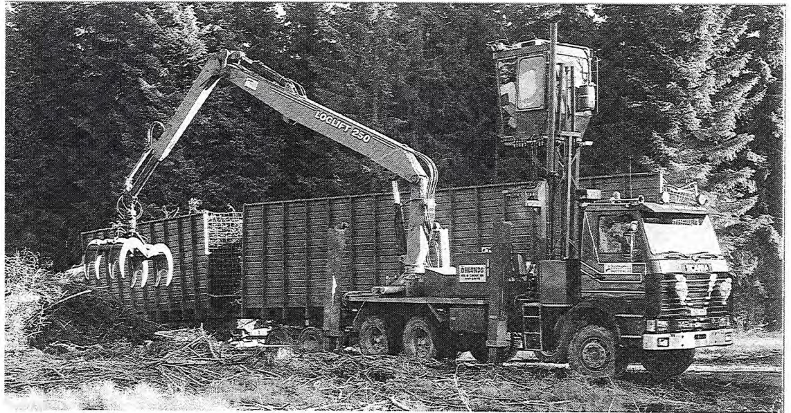
Kuva 20. Hakkuutähteiden kuormausta ja tiivistystä järeällä erilliskuormaajalla. Kuva Loglift Oy:n esite.
