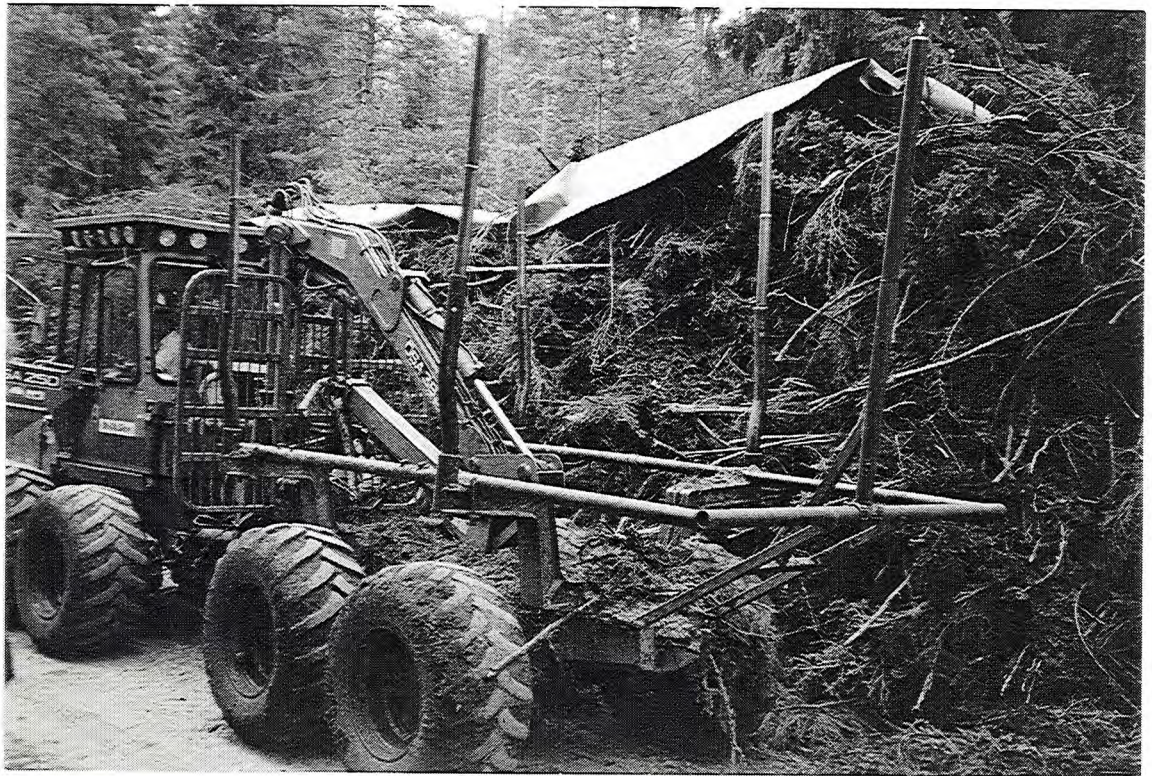
Kuva 14. Yksinkertaisin lisävarustein hakkuutähteiden ajoon varustettu kuormatraktori Ruotsissa. Valokuva Metsäteho Oy.
