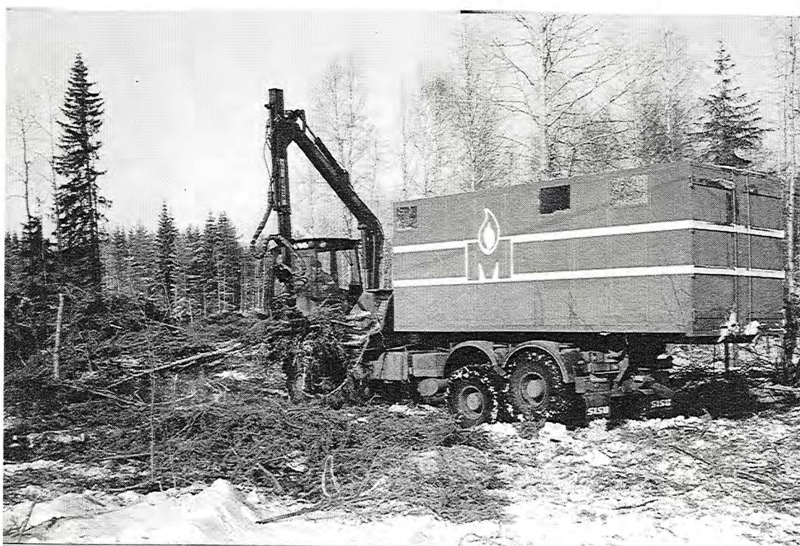
Kuva 11. Metsäenergia MetEr Ky:n valmistama koukkulavalaitteella varustettu MOHA-monitoimihakkuriauto. Valokuva Metsäteho Oy.
