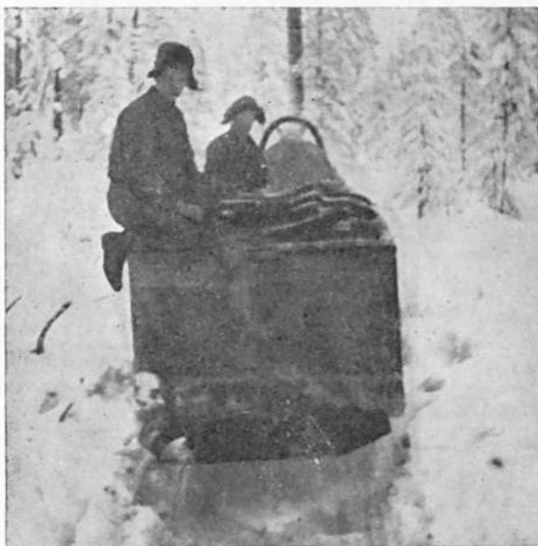
Kuva 33. — Vesilaatikko »malli Pesonen», jonka takaosassa on pieni kamina jään sulattamiseksi. Vesireikiä yksi. Levityspöytä peltiä. — Valok. K. P.
