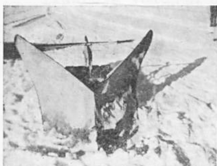
Kuva 8. — Armeijamme käyttämä »B-N etuaura», jonka metallisiivet vyöryttävät lunta. — Valok. K. P.
