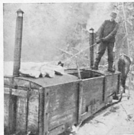
Kuva 34. — Ruotsalainen »Lassby-lämmminvesilaatikko», jossa vesi kuumentaan kahdella keskellä olevalla kaminalla. — Valok. S. D. A.
