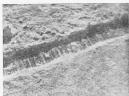
Kuva 11. — Suoran, nurin käännetyin talttaterän (malli I, kuvat 1 ja 2) huomattavan rosoinen jälki sen ollessa 30^\circ kulmassa. Raiteen keskisyvyys 22 mm.
