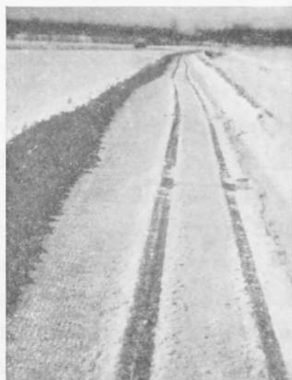
Kuva 9. — Yleiskuva vetovastusmittaus-ten suorituspaikasta. Järven jää oli aurattu puhtaaksi lumesta. Jää vastasi laadultaan suunnilleen vesitettyjen raiteiden jätää.
