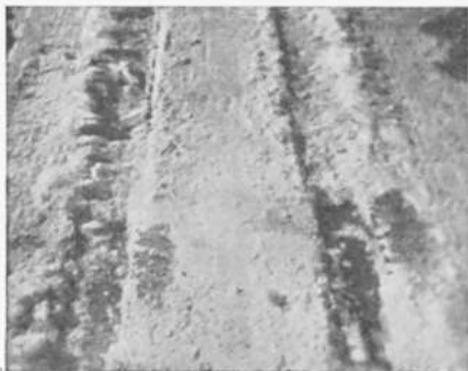
Kuva 12. — Vinon, 30^\circ kulmassa olevan talttaterän (malli II, kuvat 3 ja 4) jättämä aaltomainen jälki, jossa suurina paloina lohkeillutta jäätä. Raiteen keskisyvyys 21 mm.
