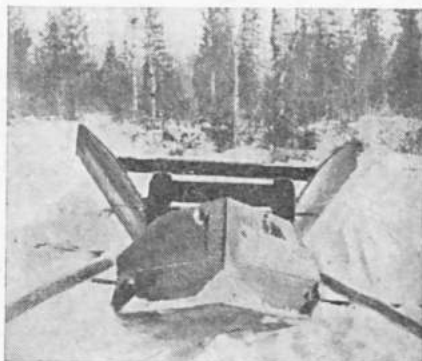
Kuva 4. — Aura-höyläyhdistelmä »malli Outa», jonka sekä korkeudeltaan säädettävä kärkiosa että levityssiivet ovat lunta työntävät. — Valok. K. P.
