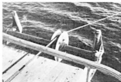
Kuva 51. 4 200...4 800 kgf vetovoimalla varppaavan höyryaluksen teräsköysi ja perärulla. Teräsköysi on liian ohut (ø 22 mm) ja perärullan läpimitta liian pieni (ø köyden keskeltä köyden keskelle 470 mm). — Photo 51. Wire rope and aft reel of a steam vessel warping at a traction power of 4 200...4 800 kgf. The wire rope is too thin (dia. 22 mm), and the diameter of the aft reel too small (dia. from middle of rope to middle of rope 470 mm).
