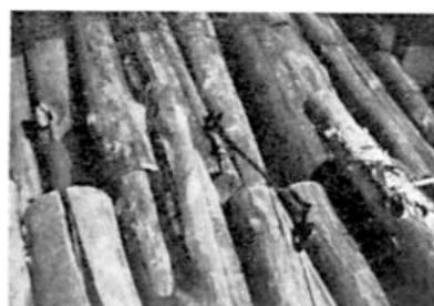
Kuva 22. Nippujonon peräkkäiset niput voidaan yhdistää S-tikkakäytkimellä. — Photo 22. Successive bundles in a chain of bundles may be connected up with a special device, S-connection.
