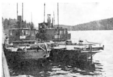
Kuva 50. Kymin Uittoyhdistyksen höyryvarppaajat »Ukko» ja »Kolmas» Pellonpään laiturissa. Laivojen pääkone 100...110 hv i, varppauskone 37...40 hv i ja vetovoima 1/1-kuormalla 4 200...4 600 kgf. Päijänteen mullikalauttojen kuljetuksessa. — Photo 50. The steam warping-boats owned by the Kymi River Floating Association »Ukko» and »Kolmas», at Pellonpää pier. The vessels have a main engine of 100...110 IHP, warping machine of 37...40 IHP and traction with full load of 4 200...4 600 kgf. Used for towage of bundle rafts on Lake Päijänne.
