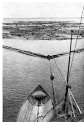
Kuva 25. 3 mullikkaa käsittävän mullikkalautan varppausta. Lautan pituus on 400 m ja leveys 90 m. — Photo 25. Warping of a bundle raft of 3 «steers» . Length of raft 400 m and width 90 m.
