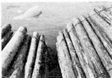
Kuva 20. Nippujen sitominen toisiinsa teräslangalla. — Photo 20. Tying up of bundles to one another with annealed steel wire.
