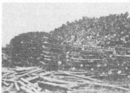
Kuva 29. Pinojen päitä. Ristikko-osan korkeus vaihteli tavallisesti 30-70 cm. Tässä se on hieman korkeampi. - Fig. 29. File ends. The height of the part stacked crosswise usually varied from 30 to 70 cm. Here it is somewhat higher.
