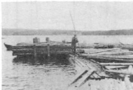
Kuva 26. Pölkkyjen vetäminen keksillä kopukan viereen. Vasemmalla vedessä kuormattavana olevat rullavaunut. - Fig. 26. Drawing the logs to the float with a boat-hook. Left: the trolley being loaded in the water.
