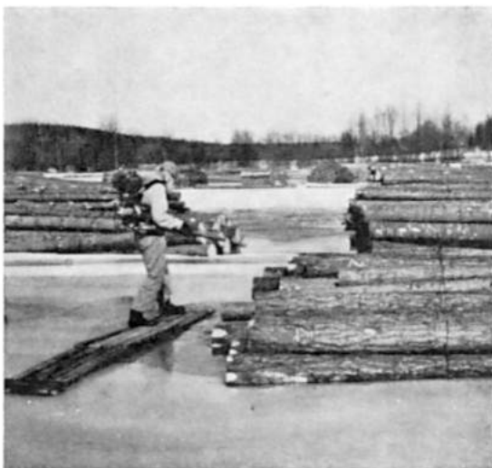
Kuva 8. Jäällä olevia nippuja ruiskutettaessa jään heikkous nippujen päiden luona ja voimakas tuuli (muovisuojus kasvojen edessä) haittasivat työtä.
