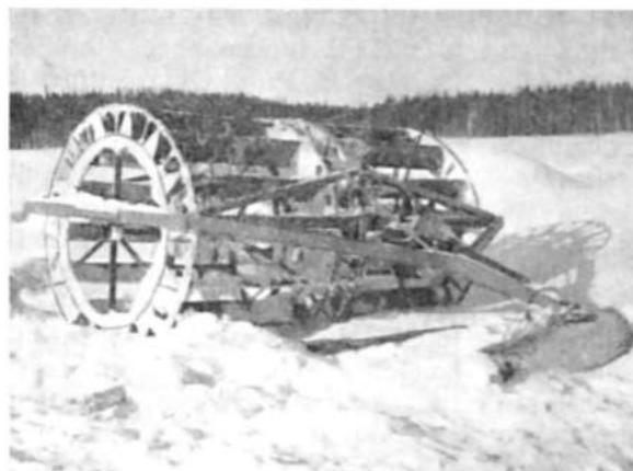
Kuva 7. Kardaanivetoisen jyrä. Vaihdelaatikossa on rajoittimella estetty muiden kuin 1. ja 2. vaihteen kytkeminen. Peruutusvaihte olisi myös saatava käyttöön.
