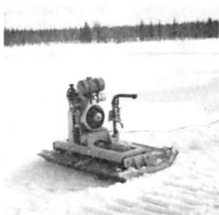
Kuva 8. ABG tärylevy lumen tiivistämistä varten. Samalla laitteella on mahdollista tiivistää myös mineraalimaata.
