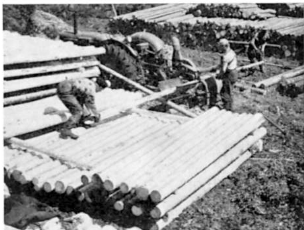
Kuva 4. 4-metrinen havupölkkyjen kesäkuorintaa traktori-käyttöisellä Veikko II koneella. Työryhmä 3 miestä. Työn keventämiseksi käytetään pölkkyjen siirtelyssä koneelle vip-paustelaa.
