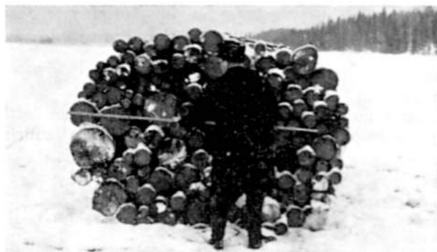
Kuva 1. Ristiinmitauksessa käytetään 2 m pituisia, osiksi taitettavaa puumittaa. Suurin halkaisija ei läheskään aina ole vaakasuunnassa. Nipun samasta päästä mitataan myös toinen, edellistä vasten kohtisuorassa oleva suurin halkaisija.
