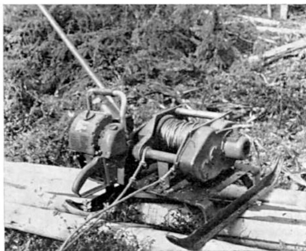
Kuva 11. V.N. moottorisahavintturi. Vinsin käyttövoimana on Homelite tai vastaava moottorisaha.
