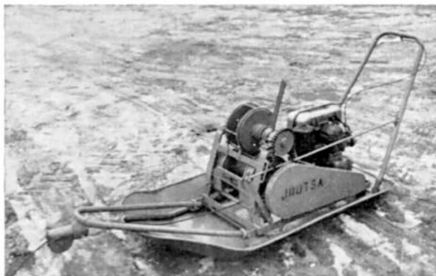
Kuva 10. 1-rum- puiseen Joutsa vintturiin on liitet- tävässä palautus- köysirumpu, jol- loin vintturi toi- mii 2-rumpuisena.
