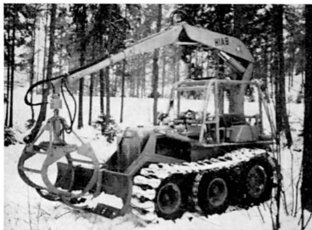
Kuva 3. Fiat 50 C metsätraktori varustettuna hydraulisella kouranosturilla.
