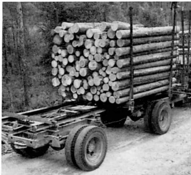
Kuva 3. Liikkuvilla pankoilla varustettu perävaunu. Takimmaisille pankoille tuleva kuorma on valmis.
