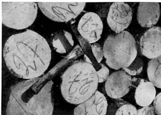
Kuva 5. Merkkauk- vasara ja sillä lyö- tyjä merkkejä.
