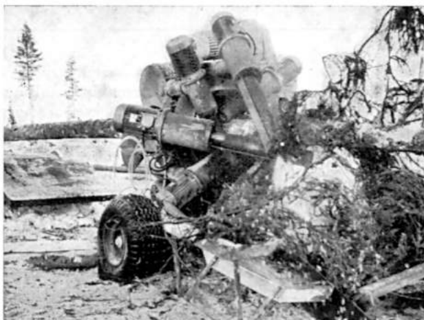
Kuva 6. Sundin siirrettävä karsimiskone. Sen karsimiseliminä on 8 sylinterimäistä, hydraulisesti ohjattavaa jysrintä.
