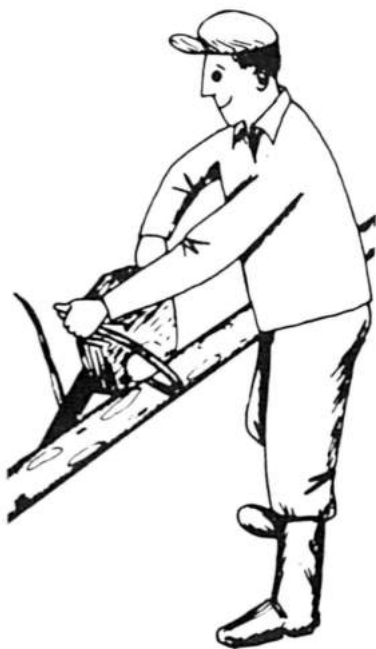
Kuva 4. Rungon ulkosivun karsinta.
