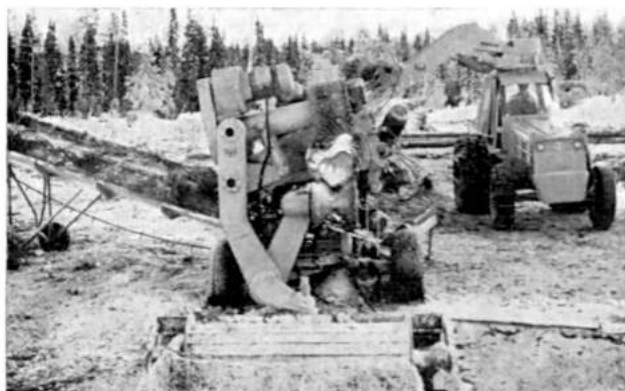
Kuva 7. Sundin karsimisasema, jossa nähdään oikealla hydraulinen nostolaite, keskellä karsimiskone syöttöteloineen ja vasemmalla kuorikuljetin.
