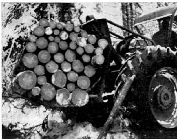
Kuva 7. Paperipuiden juontoa 1...2 \text{p-m}^3 :n suuruisina nipuinä Timberjackin taakse asennettua kehystä apuna käyttäen. Lyhyillä juontomatkoilla tämä nipujuonto on usein osoittautunut kokorunkojuontoa tehokkaammaksi.
