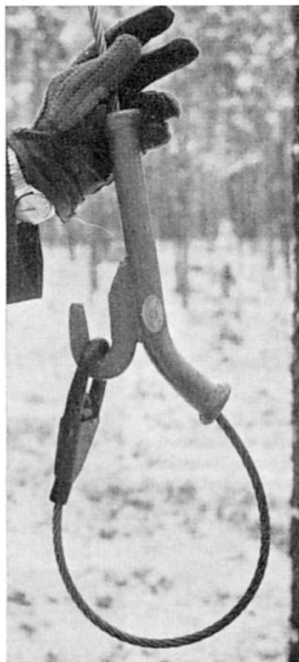
Kuva 8. Ns. vaijeritaakan sitomiseen voidaan käyttää ruotsalaista, itses-tään laukeavaa, köydessä vapaasti liikkuvaa EIA-hylsykoukkuja köyden päässä olevine Orsa-silmukoineen.
