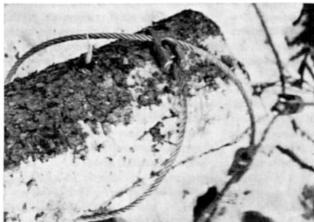
Kuva 5. Timberjackilla juonnettaessa rungot kiinnitetään vintturin pääköyteen lyhyillä kiinnitysköysillä Esco Bardon-liukukiinnittimien ja kiinnitysköyden päissä olevien teräshelojen avulla.
