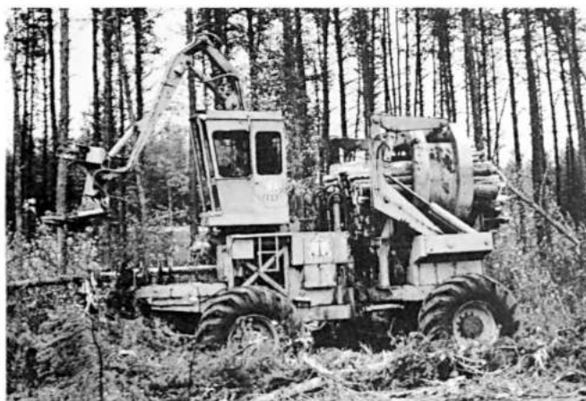
Kuva 7. Larson L-56 Shortwood Stump Processor. Valmistaja: Larson Woodlands Research Ltd., Kanada. Tekniset tiedot: Koneen suurin kaato- ja katkaisuläpimitta on 41 cm. Puomin päässä olevan kaatolaitteen ulottuvuus on 5.8 m, jolloin nostokyky on 1 000 kg. Puomin kääntökulma on 190^\circ . Puu siirretään vaakasuorassa karsintalaitteelle. Erilliset pihdit syöttävät puun jaksoittain automaattisesti kaadosta riippumatta koneen edessä olevien yhden kiinteän ja kahden liikkuvan karsintaterän lävitse. Katkotut 8':n pölkkyt siirtyvät koneen takaosaan, josta ne alakautta syötetään 8.1 p-m 3 vetävään kuormatilaan. Koneen paino on 15.8 t, leveys 3.8 m ja pituus 7.6 m. Arvioitu tuotos: 15...18 p-m 3 /h, kun rungon koko on 0.18 k-m 3 ja leimikon tiheys 95 p-m/ha. Hinta-arvio: $ 80.000...95.000. Kehitysvaihe: 4 konetta on koekäytössä. (Metsäteho)
