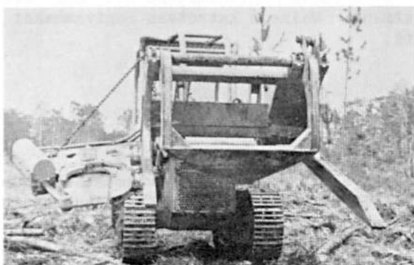
Kuva 3. Fleco-kaato-kasauslaite. Valmistaja: Fleco Corporation, USA. Tekniset tiedot: Laitteeseen kuuluu leikkuri ja siihen liittyvä haarukkuormain, jotka asennetaan telaketjutraktoriin. Suurin kaatoläpimitta on 38 cm. Haarukka aukeaa 112 cm:iin ja sulkeutuu 15 cm:iin. Laitteen leveys on 264 cm ja paino 1.6 t. Kaadon jälkeen puu otetaan kuormaimelle, johon puita kasataan vaakasuoraan asentoon koneeseen näiden poikkisuuntaan. Kuormaimen kapasiteetti on noin 10 runkoa. Arvioitu tuotos: 90...120 puuta/h. Hinta-arvio: Kaatolaite U.S. $ 6.500. Kehitysvaihe: Sarjavalmistus on käynnissä. Saattavana varastosta. (Pulpwood Production)
