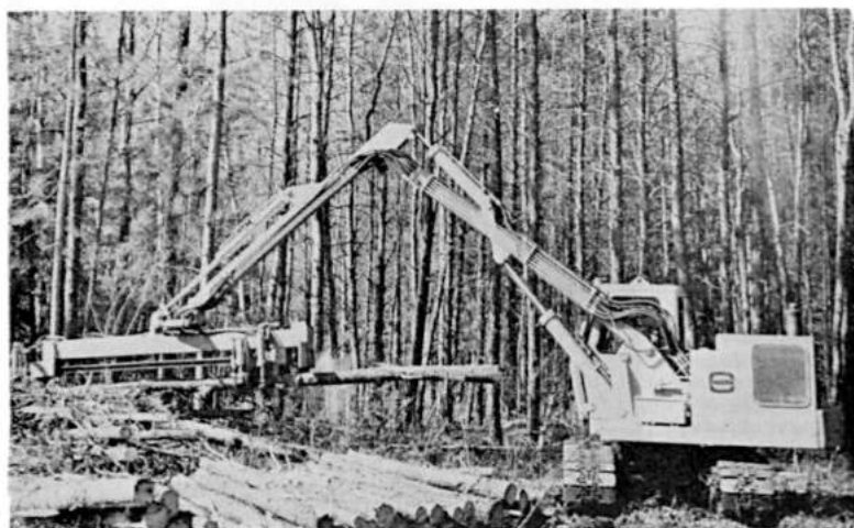
Kuva 9. Omark Tree Harvester. Valmistaja: Omark Industries Inc., USA. Tekniset tiedot: Koneen suurin kaato- ja katkaisuläpimitta on 51 cm. Puomin päässä olevan kaatolaitteen suurin ulottuvuus on 7.6 m, jolloin nostokyky on noin 1 700 kg. Toimintasäde on 360^\circ . Puomissa on kaksi karsintayksikköä, joiden välissä liikkuvat syöttöpihdit. Kaadon jälkeen puu asetetaan vaakasuoraan, syötetään tyvi edellä karsintaterien läpi ja katkaistaan kaatolaitteena toimivalla sahalla halutun pituiseksi. Telaketjuosan pituus on 3.3 m, leveys 2.4 m ja koneen kokonaispaino 14.4 t. Arvioitu tuotos: 45 puuta/h tai 11 p-m 3 /h, kun rungon koko on 0.25 k-m 3 . Hinta-arvio: U.S. $ 40.000. Kehitysvaihe: Ensimmäiset koneet ovat käytössä USA:ssa. (Pulpwood Production)
