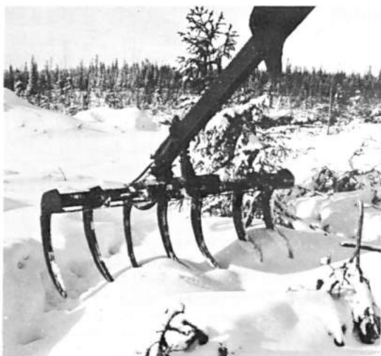
Kuva 1. Hakkutähteiden kasaukseen suunniteltu harava. Sen leveys on 180 cm ja piikkien pituus 60 cm. Valok. Metsäteho
