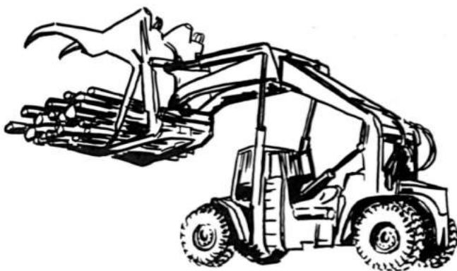
Kuva 4. Kurottajatruckki puutavaran siirtokoneena
