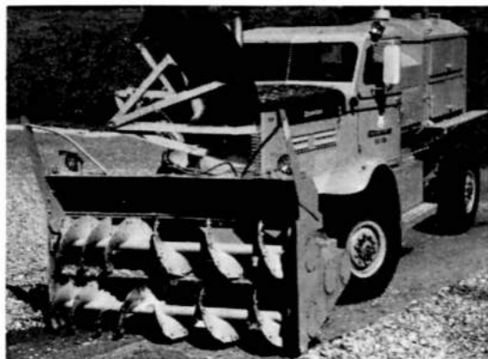
Kuva 3. Kuorma-auton eteen asennettu Sicard-lumilinko hakekasaa siirtämässä. Valok. APA
