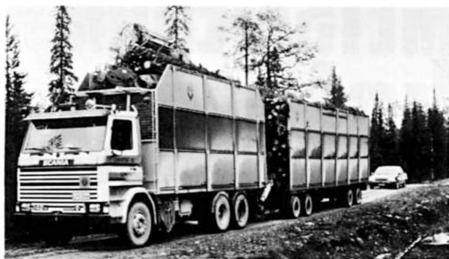
Kuva 1. Koko- ja osapuunkuljetuksen kehittämiseksi Veitsiluoto Oy ja Metsäteho suunnittelivat ja rakennuttivat osapuuväyän. Käyttökokeet ovat meneillään. Kaikki valok. Metsäteho
