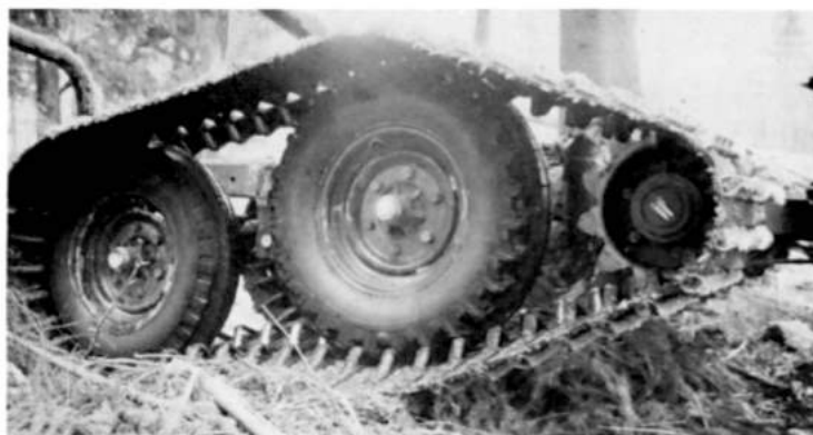
Kuva 3. Kärkipyörävetoinen voimansiirto parantaa Farmi Tracin lumessa-liikkumiskykyä ja pienentää myös pintapaineita. Kärkipyöräveto lisää telin pituutta, mutta ei pienennä kuormatilan tilavuutta
