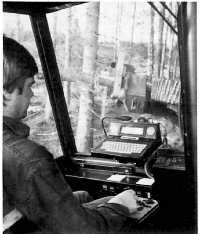
Kuva. Mittauksen liittäminen puutavaran valmistukseen monitoimikoneella antaa hyvät mahdollisuudet mittauksen automatisoimiseen ja mittausvirheiden vähentämiseen. Valok. Laitteen valmistaja
