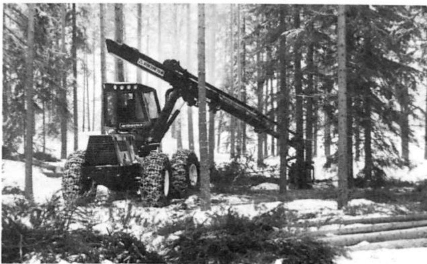
Kuva 1. Yhä suurempi osa puumäärästä hakataan koneellisesti. Yleisimmän konetyypin – kuormainharvesterin – käyttöä tehostettiin monin tutkimuksin. Kaikki valok. Metsäteho
