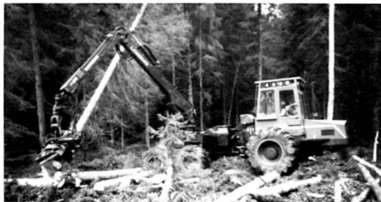
Kuva 1. Lokomo 919/750H -kuormainharvesteri. Kaikki valok. Metsäteho
