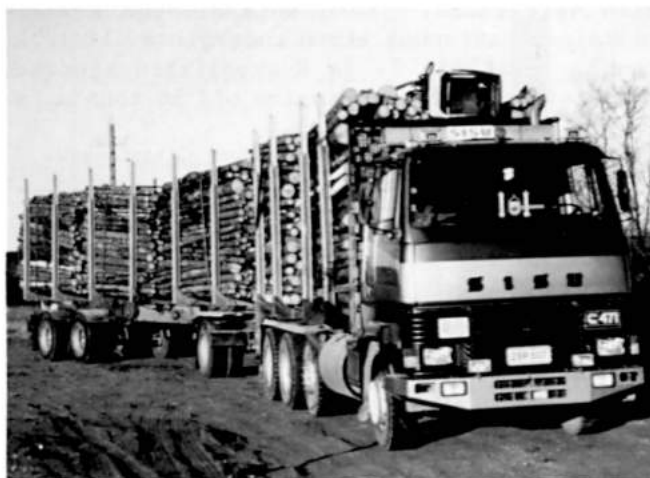
Kuva 1. 7-akselinen puutavara-autoyhdistelmä, jossa on 4-akselinen vetoauto ja 3-akselinen perävaunu. Valok. Metsäteho
