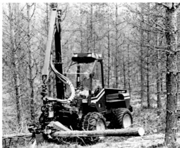
Kuva 1. FMG 0470 Motokärppä. Valokuva ja tekniset tiedot valmistajalta, FMG Lokomo Forest Oy
