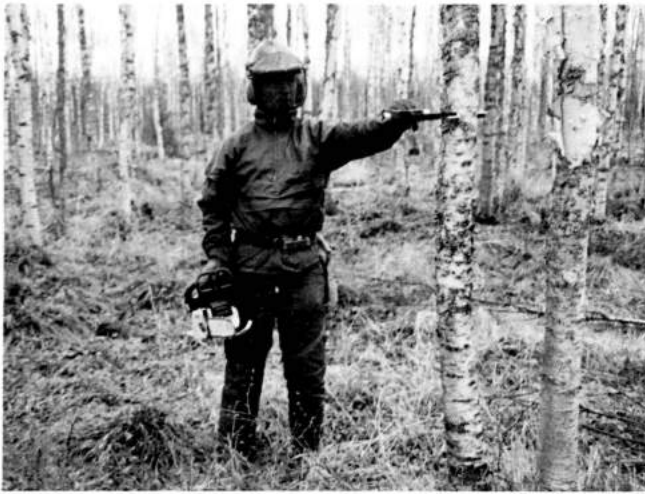
Kuva 3. Rekisteröivä mittakaulain mittaa rinnankorkeusläpimitan tarkasti. Valok. Masser Oy
