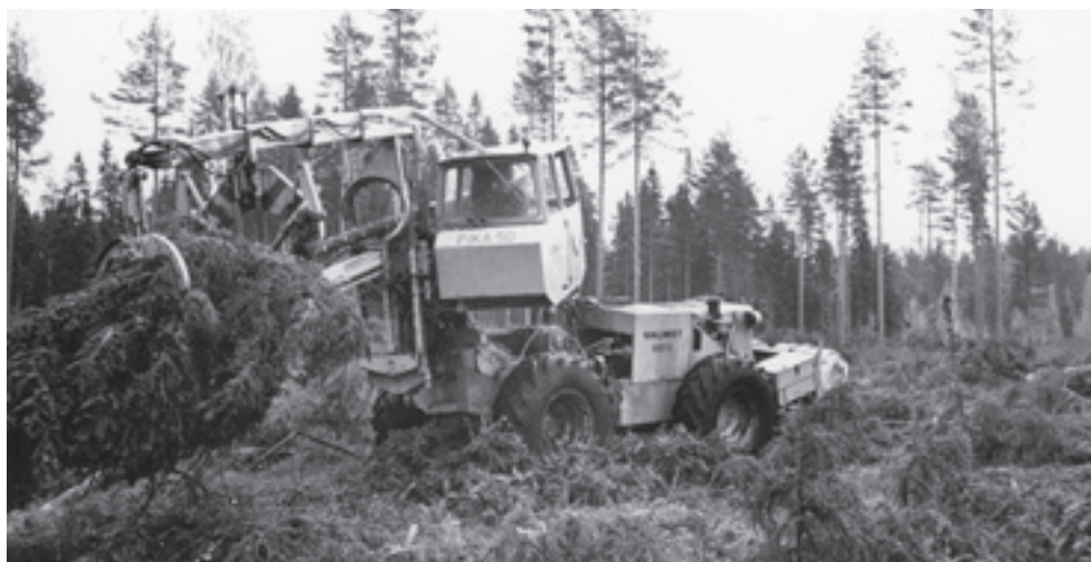
Hakkuu alkoi koneellistua 1960-luvun lopulla, kun keksittiin runkojen karsintaan ja katkontaan soveltuvat koneet (prosessorit). Puut piti kaataa niitä varten metsurityönä. Sakari Pinomäki kehitti ensimmäisen suomalaisen prosessorin, joka sai nimen Pika 50. Tampereen seutu 1970.
