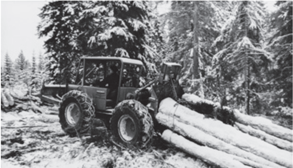
Ensimmäiset laahusjuontotraktorit tuotiin Amerikasta, mutta kohta käynnistettiin myös kotimainen valmistus. Kuvassa Valmet-metsätraktori tuomassa kokorunkokuormaa varastolle. Runkoina korjuu ei istunut suomalaisiin olosuhteisiin ja hiipui pois tavaralajimenetelmän tieltä. Petäjävesi 1964.
