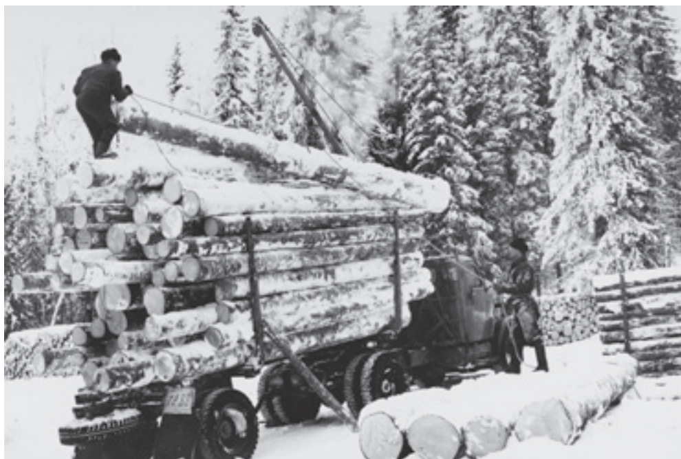
Puoliperävaunulla varustetun auton kuormausta. Mekaaniset puomikuormaimet yleistyivät puutavara-autoissa 1950-luvulla. Ne helpottivat ja nopeuttivat tukkien kuormausta olennaisesti, mutta eivät soveltuneet kuitupuulle. Työ oli riskialtista, kuten kuvasta voi päätellä. Kuva vuodelta 1958.
