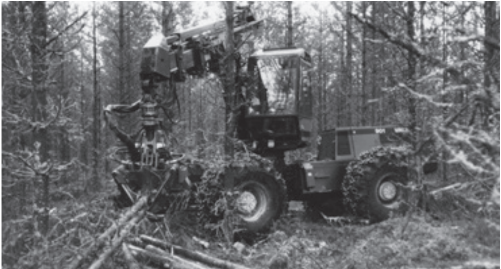
Ketterät kuormainharvesterit paransivat olennaisesti harvennushakkuiden koneellistamisedellytyksiä. Kuvassa hakataan ensiharvennusmännikköä joukkokäsittelymenetelmällä Valmet 901-kuormainharvesterilla. Mänttä 1988.
