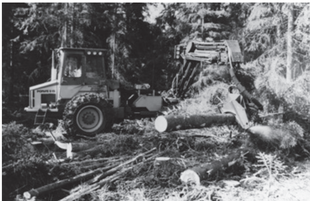
Pian kuormainprosessereihin yhdistettiin myös puiden kaatotekniikka, jolloin syntyivät kuormainharvesterit. Ne valtasivat hakkuukonemarkkinat 1980-luvun puolivälistä alkaen. Kuvassa yrittäjä Kari Rantamaan omistama Ponsse HS15-kuormainharvesteri Halikossa vuonna 1988.
