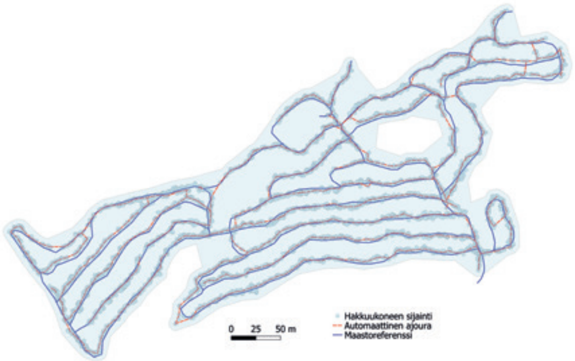
Hakkuukonedatasta voidaan tuottaa automaattisesti harvennushakkuun ajouraverkosto korjuujäljen seuranta varten. Kuva: Metsäteho Oy.
