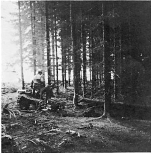
Kuva 1. Kuorman kerääminen puunetelmässä lumettomana aikana. Kaikki kuvat valok. Metsäteho
