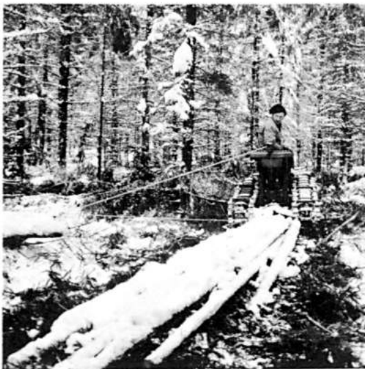
Kuva 3. Kuorman kerääminen laahusjuontoon perustuvassa tavaramenettelyssä talvella
