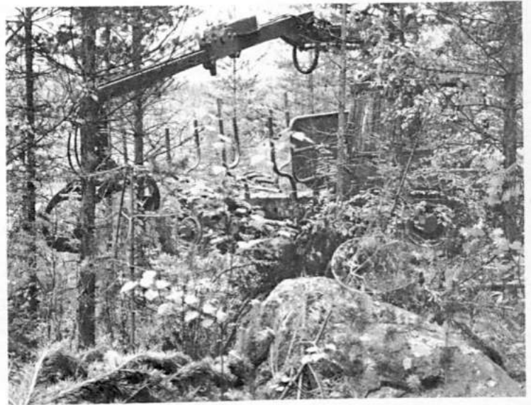
Kuva 3. - Jäävä puusto haittaa huomattavasti taakan ottamista suurimmilta kuormaimen ulot- tumilta; suurin ottoetäisyys on maanpinnan tasossa mitattuna 9.3 m. Valok. Metsäteho
