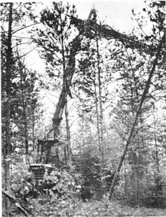
Kuva 2. Kuormaustekniikkaa. Taa- kat nostettiin puiden latvojen yli kuormaan. 7-metrinen taakkojen kääntely jäävän puuston lomassa olisi ollut lähes mahdotonta. Valok. Metsäteho
