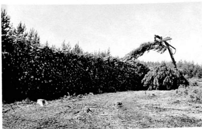
Kuva 4. Purkaminen varastolla tapahtui 3...4 m korkeaan varastopinoon. Valok. Valmet Oy
