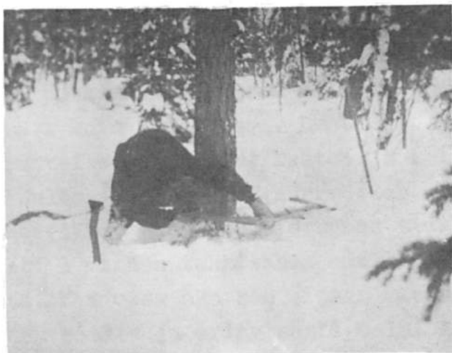
Kuva 1. - Tukin kaatoa jännesahalla. Lumi ja pensaat yms. raivattava puun molemmin puolin lähes 1 m etäisyydeltä. Kanto tahtoo jäädä pitkäksi. Valok. Työtehoseura.
