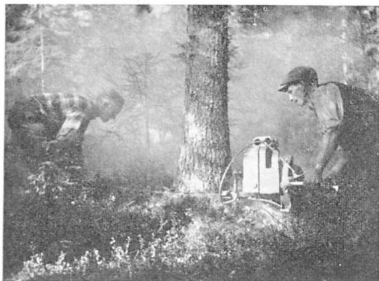
Fig. 1. Tvåmans-motorsåg i fällningsarbete.
