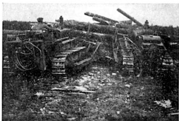
Kuva 2. — Telakasan työntö kahdella traktorilla. International TD-14 (vas.) ja TD-9. Välitelat ovat hajoittaneet kasan. Huom. Oikealla oleva traktori pyrkii nousemaan kasalle. Valok. H. Olkinuora, Muonio, Muonionjoki, 1949.
