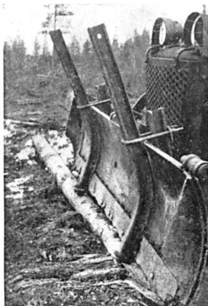
Kuva 1. — International TD-14:n raivauspuskurin korkeutta on lisätty rataakiskoilla tukkien veteen työntöä varten. Valok. A. Tuovinen, Muonio, Pakajoki, 1949.
