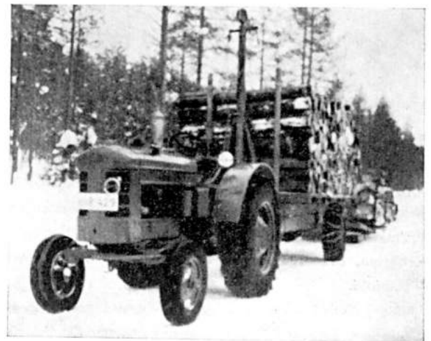
Kuva 10. Vetäväpyöräisellä perävaunulla varustettu maataloustraktori on erinomaisen maastokelpoinen, ja sen mäkiennousukyky on hyvä. — Valok. Metsäteho
