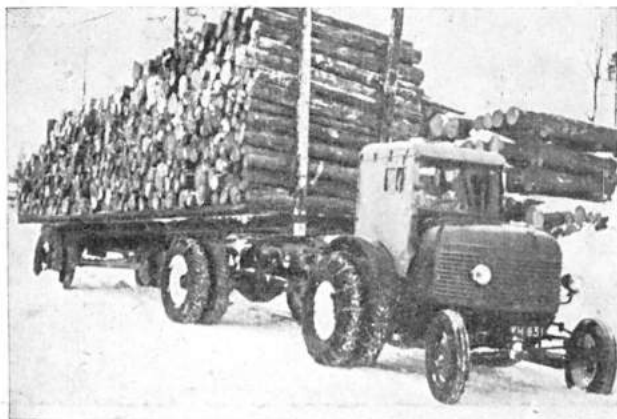
Kuva 11. 2-akselisella perävaunulla varustettu traktori. Voima siirretty traktorista perävaunun etuakseliin. Mäkiennousukyky hyvä, mutta maastokelpoisuus huonompi kuin kuvassa 10 esitetyllä mallilla. Kuorman suuruus n. 24 p-m 3 . — Valok. Metsäteho
