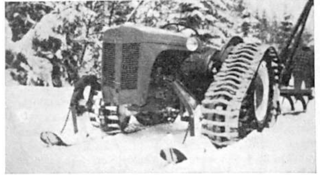
Kuva 2. Kumitelaketjuilla ja suksilla varustettu, n. 1,1 tn painoinen maataloustraktori. Lisävarusteitten ansiosta ajo lumessa on mahdollista. — Valok. Metsäteho.
