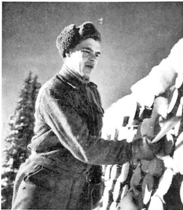
Kuva 1. Päämerkkivasaran käyttö on nopeaa, mutta jälki on tavallisesti epätydyttävää. Valok. Poutiainen. — Fig. 1. The use of an end-marking hammer is speedy but the result usually poor. Photo by Poutiainen.
