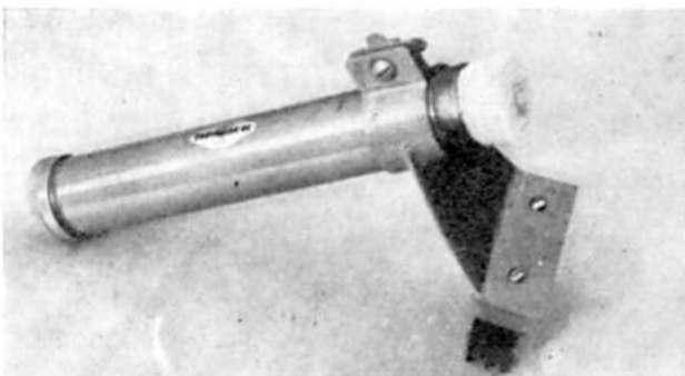
Kuva 3. Pölkyn päiden ruiskumaalauksella saadaan hyvin näkyvät uittomerkit, mutta maalin hinta nousee liian suureksi. Valok. Metsäteho. — Fig. 3. Spray painting of the ends of the log. Photo by Metsäteho.
