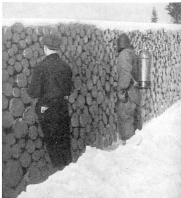
Kuva 1. Koepuita merkitään. Marrask. —53 kuorittu kuusi, veteenpano 7.5.54, uittohukka 13,5 %. — Valok. J. Salmi
