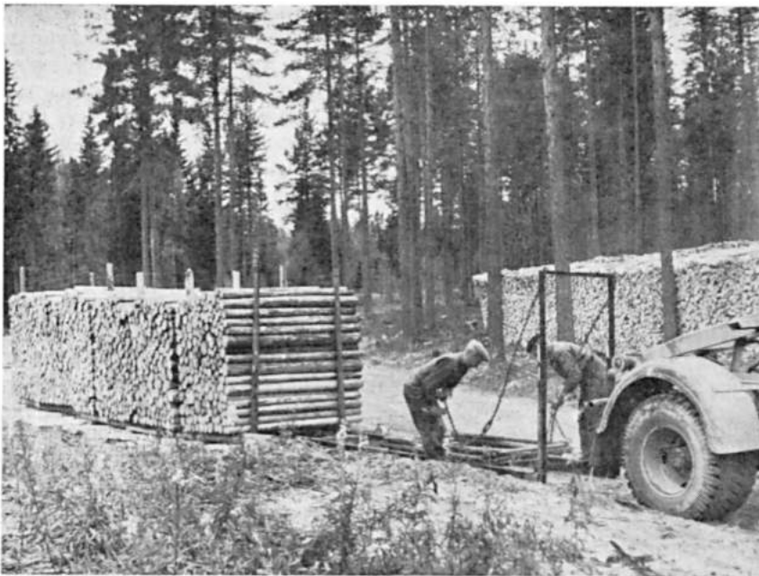
Kuva 2. Nokia Osakeyhtiössä kehitettyä nippualustakuormausta. Auto työntää tai vetää vintturin avulla tyhjän alustan nippumittapinon alle. — Valok. kirj.
