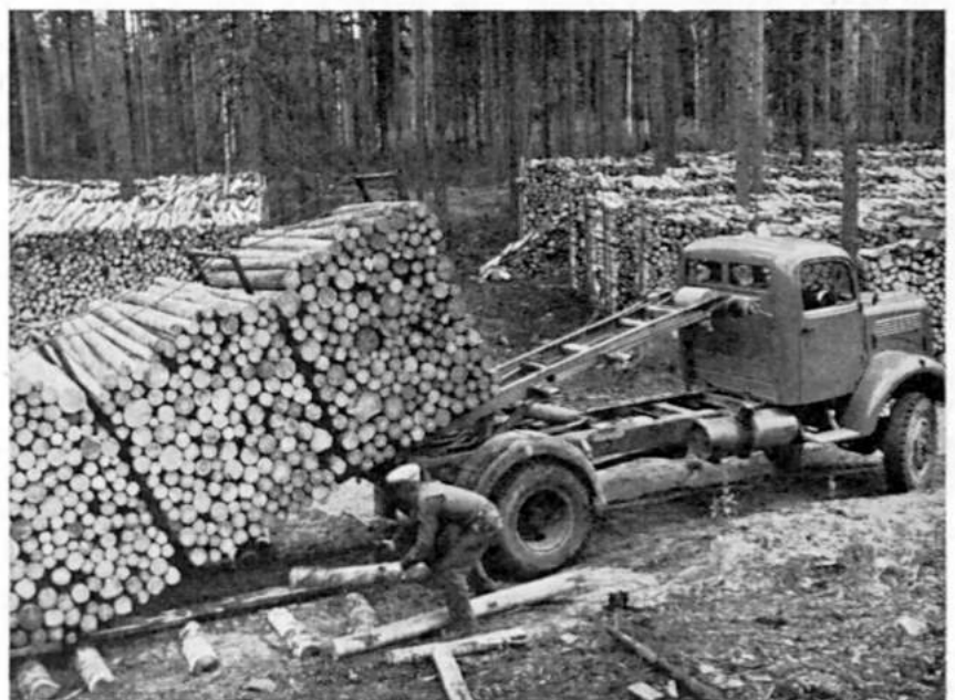
Kuva 3. Kun päästuki ja nippujen väliset tuet on asetettu paikoilleen, alusta vedetään auton päälle samalla tavalla kuin vaihtolava. — Valok. kirj.
