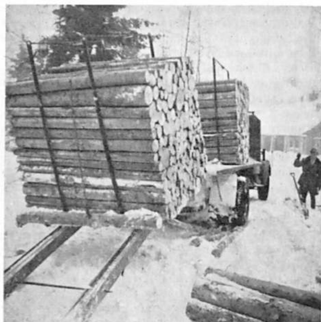
Kuva 1. Aktiebolaget J. W. Enqvist Osakeyhtiössä kehitettyä kehikkokuormausta. Tavara ladotaan maassa olevaan kehikkoon, joka sitten vedetään ohjaamon takana olevalla vintturilla auton lavalle. — Valok. kirj.
