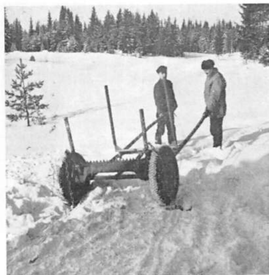
Kuva — Photo 2 Pyöräajoneuvo m/VAPO-Ahlgren varustettuna aisojen varaan kiinnitetyllä lisäpankolla 2—2½ m pinotavaran ajoa varten. — Valok. VAPO.
