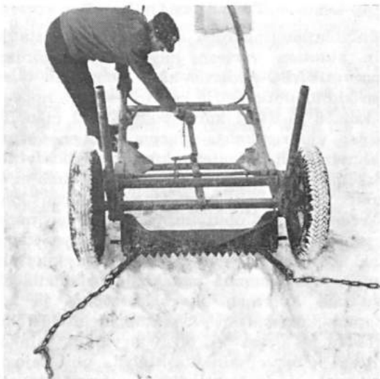
Kuva — Photo 1 Hevosvetoinen metsäkuljetusajoneuvo m/VAPO-Ahlgren pankko laukaistuna. — Valok. VAPO.
