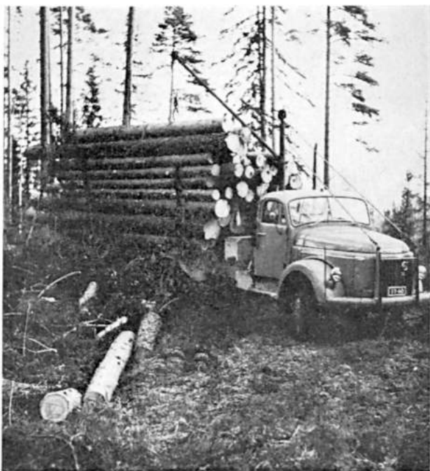
Kuva 2. Kovapohjaisessa ja pinnaltaan tasaaisessa maastossa ei vetävällä etu- ja taka-akselilla varustettua autoa käytettäessä tarvitse suorittaa sanottavia tietöitä. Riittää, kun pahimmat auton liikkumista estävät kannot lyhennetään, kivet poistetaan ja kuopat täytetään. — Valok. Erkki Vaalle.
