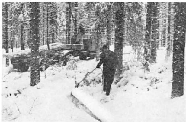
Kuva 3. Harvennusleimikossa pystyy jäänyt puusto hidastaa pölkkyjen juontamista. Jos työskentelyssä noudatetaan riittävää varovuuutta ja jos kuormauslaitteen vaijeria ei tueta puihin, puusto säilyy käytännöllisesti katsoen vahingoittumattomana. — Valok. Metsäteho.
