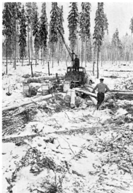
Kuva 4. Pölkkyt voidaan ensin juontaa auton viereen kasaan ja kuormata sitten kasasta. Toinen ja useissa tapauksissa nopeampi työskentelytapa on kuormata pölkkyt suoraan juonnon jälkeen. — Valok. Metsäteho.
