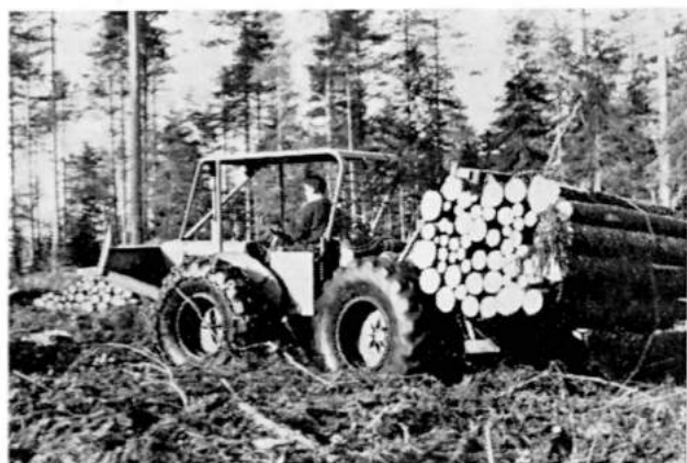
Kuva 7. Kuormattuna-ajoa nipputelinettä käyttäen. Fig. 7. Driving loaded with a bundle carrier.
