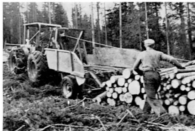
Kuva 2. Ensimmäisen kasan veto kuormaan vintturin teräsköydellä.
