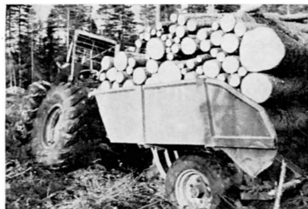
Kuva 4. Täysin kuormattu Valmet-maastotraktorin ja juontokärryyn malli Läkipohja yhdistelmä ajamassa varastolle.
