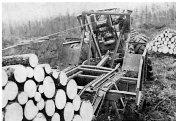
Kuva 1. Valmet-maastotraktorin hinaama juontoajoneuvo malli Läkipohja. — Kaikki kuvat valok. Metsäteho.
