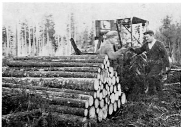
Kuva 5. Kasan kuormausta nipputelinettä käyttäen. Fig. 5. Loading of a stack by bundle carrier.
