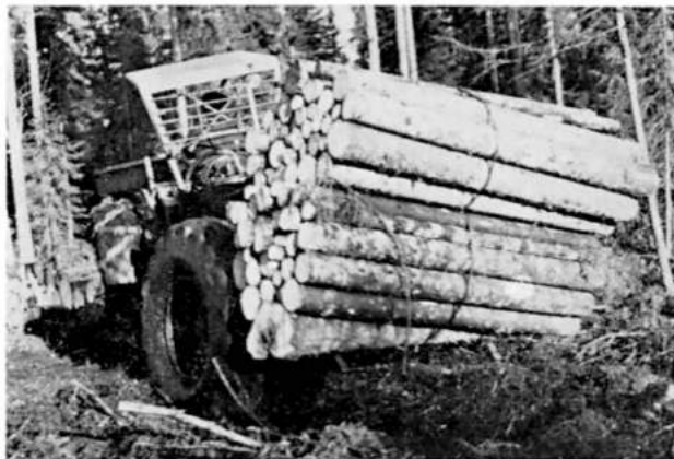
Kuva 8. Nipputelineeseen voidaan kuormata useita kasoja. Fig. 8. It is possible to load several stacks into the bundle carrier.
