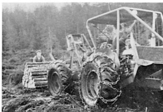
Kuva 6. Kasan veto vintturin teräsköydellä nipputelineeseen. Fig. 6. Hauling of a stack by winch steel cable onto the bundle carrier.
