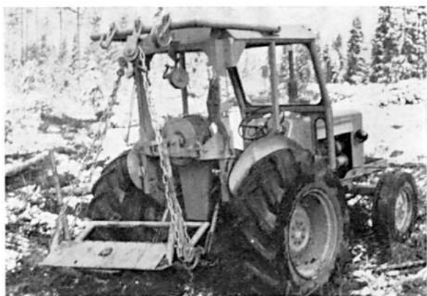
Kuva 1. Jukka-erikoisjuontopankolla ja Jukka-vintturilla varustettu Valmet 361 D. — Valok. Metsäteho.
