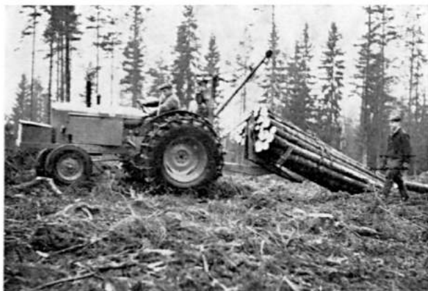
Kuva 5. 4 m paperipuiden juontoa TR-hydropankollisella Nuffield 10/60 -traktorilla. — Valok. Metsäteho.
