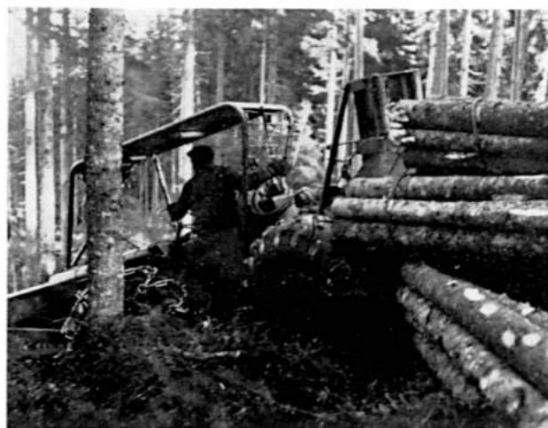
Kuva 8. 4 m paperipuiden kuormausta Valmet Terra 465 -maastotraktoriin vaikeassa maastossa. — Valok. Metsäteho.
