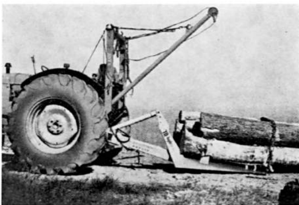
Kuva 4. TR-hydropankolla ja Jukka-vintturilla varustettu Nuffield 10/60. Pankko on kuormausasennossa. — Valok. Kesko Oy.
