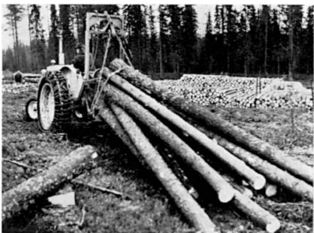
Kuva 3. Sahatukkien juontoa Jukka-pankollisella Ford 5000-maataloustraktorilla. — Valok. Metsäteho.
